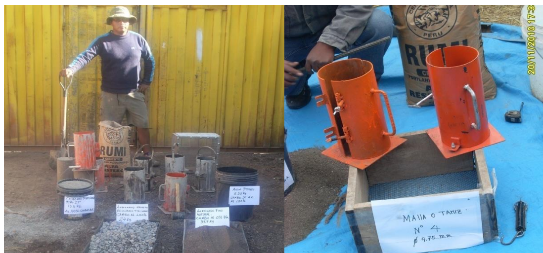
Foto N° 03: Materiales y equipo para la elaboración de las probetas de Concreto con Agregado Reciclado y Normal.
