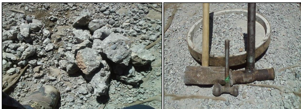
Foto N° 02: Agregado-Equipo de triturado del agregado reciclado.
