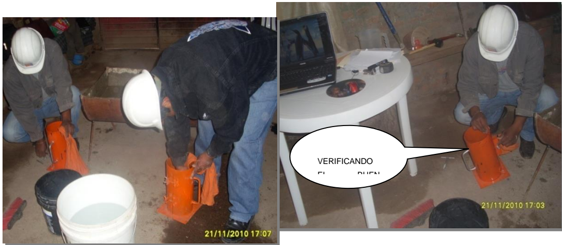
Foto Nº 04: Verificando el buen estado de los Probetas, y por supuesto realizando la limpieza de los mismos
