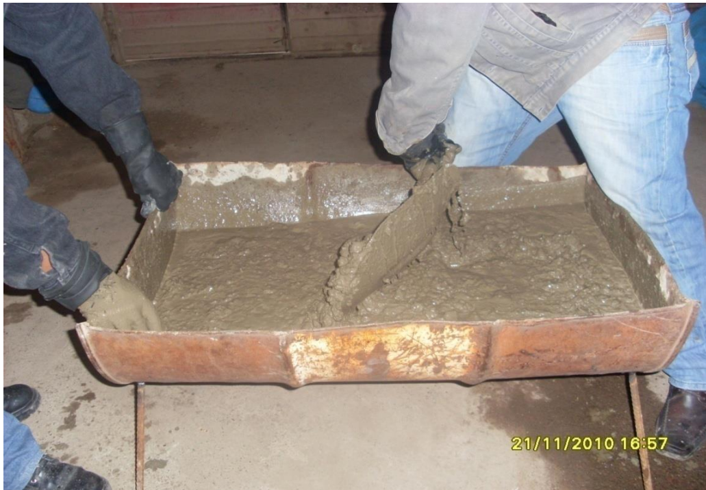
Foto N° 07: Procedimiento de mezclado manual de los componentes.
