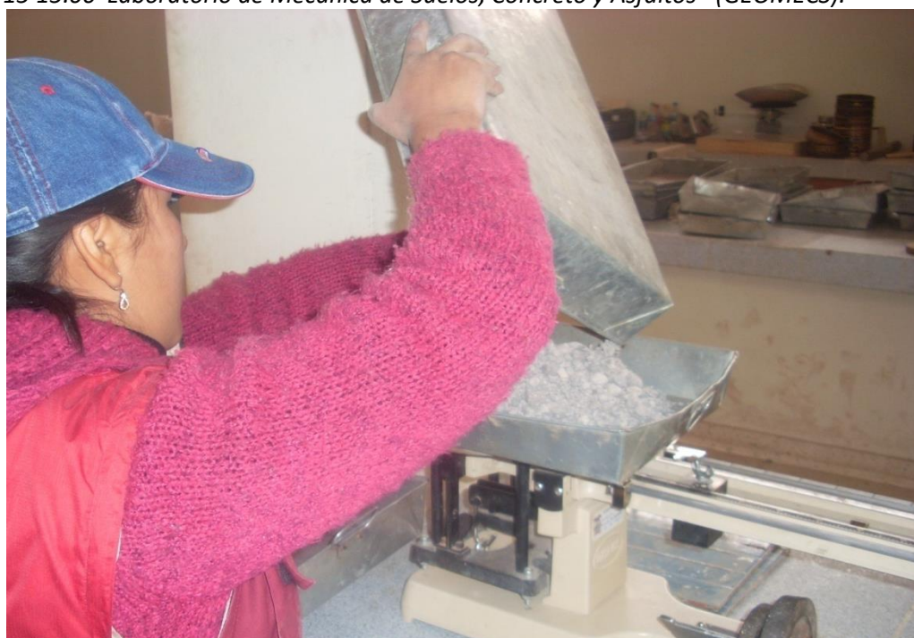
Foto Nº 11: Peso retenido por el tamiz Nº12, del total de la muestra ingresada a la Maquina de Ángeles 5.0 kg. Laboratorio de mecánica de suelos, (GEOMECS).
