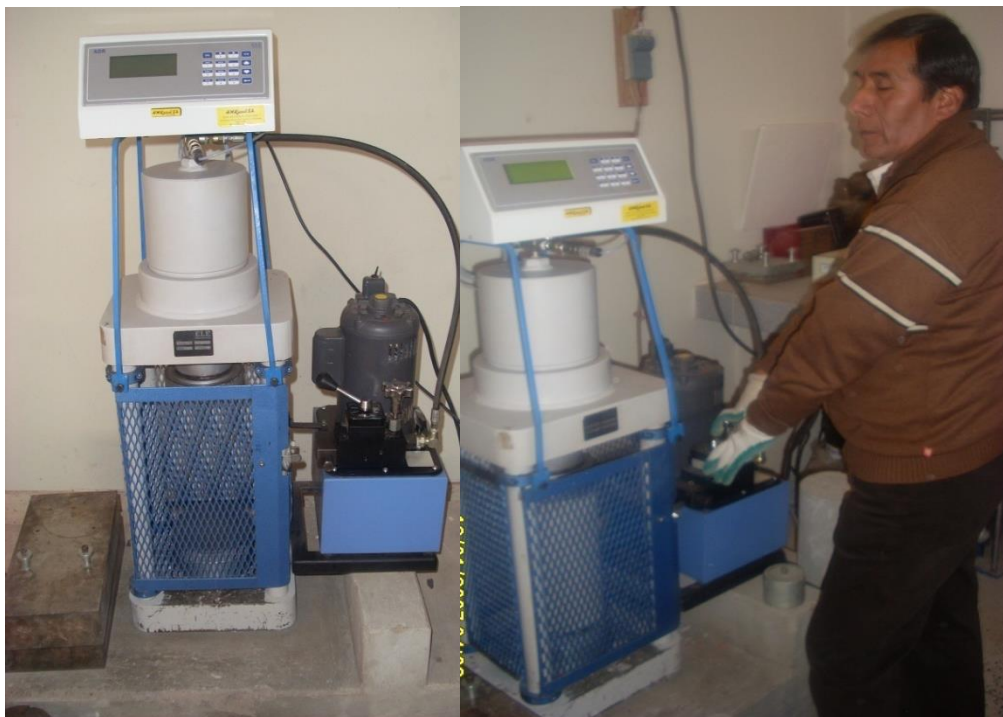
Foto N° 08: Procediendo del ensayo a la compresión del concreto normal y concreto reciclado en la Prensa hidráulica Laboratorio de mecánica de suelos, concreto y asfaltos – GEOMECS.
