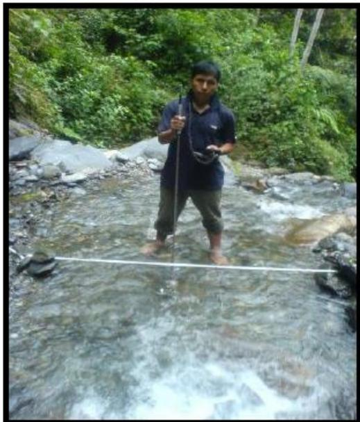
*Foto N° 07 Realizando el aforo con el instrumento de correntómetro de la fuente hídrica superficial Kasungatiari*
