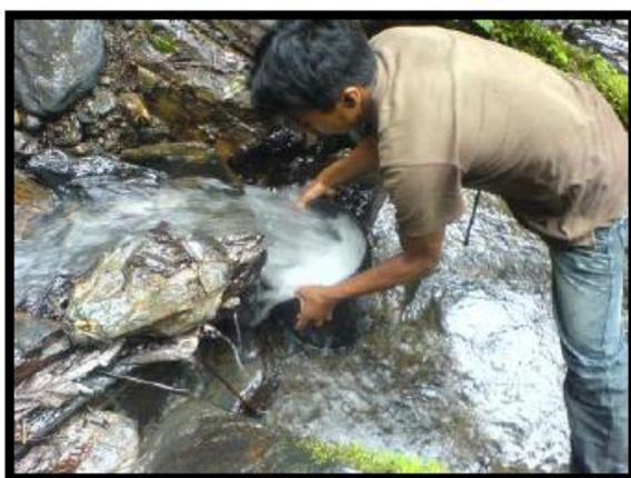
*Foto N° 09 Realizando el aforo de la fuente hídrica superficial Manuntuari, por el método volumétrico.*
