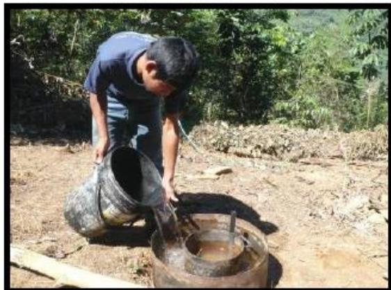
*Foto N° 04 Realizando las pruebas de infiltración.*
