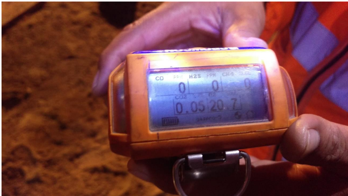
FOTO. 2: monitoreo de gases en el área de trabajo
