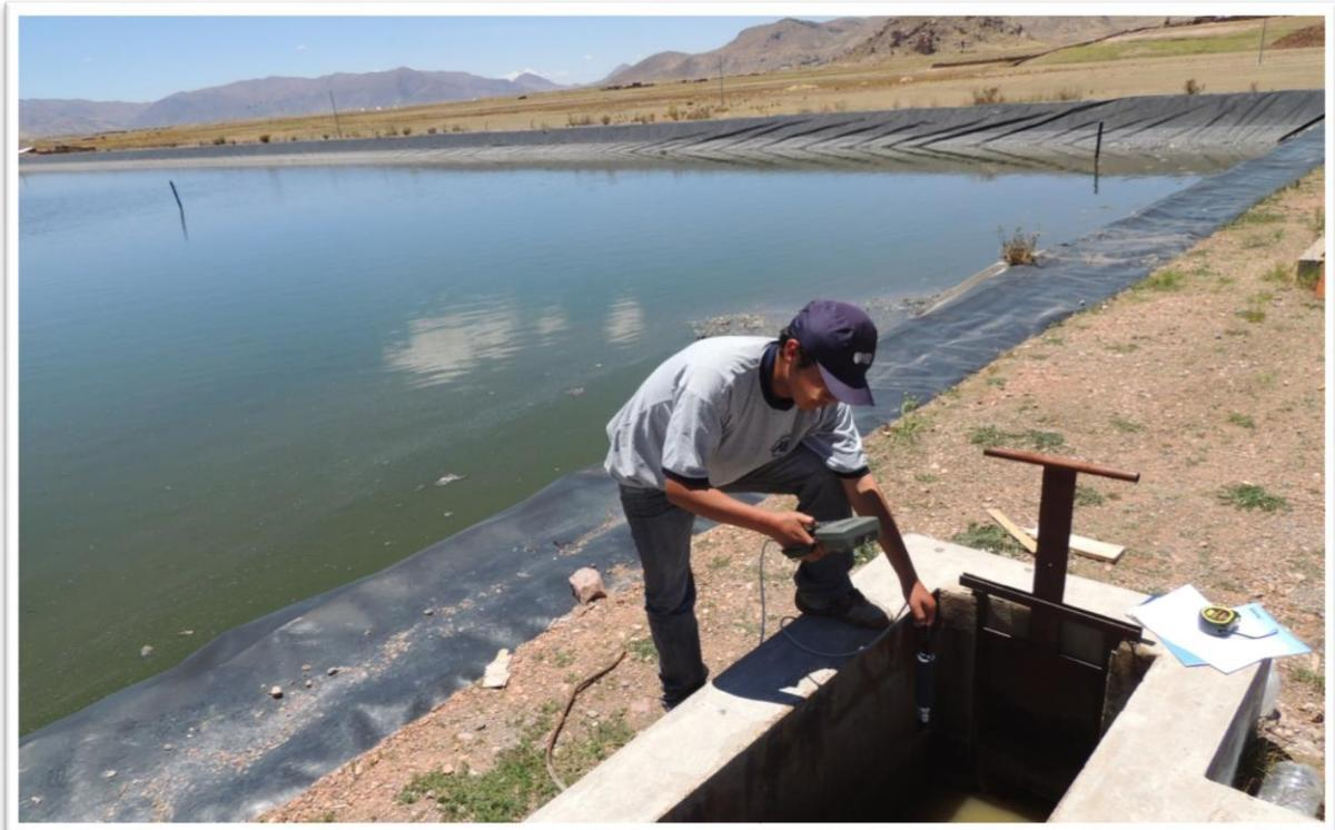
**Vista 05.** Medición de parámetros operacionales en el afluente del sistema de lagunas.
