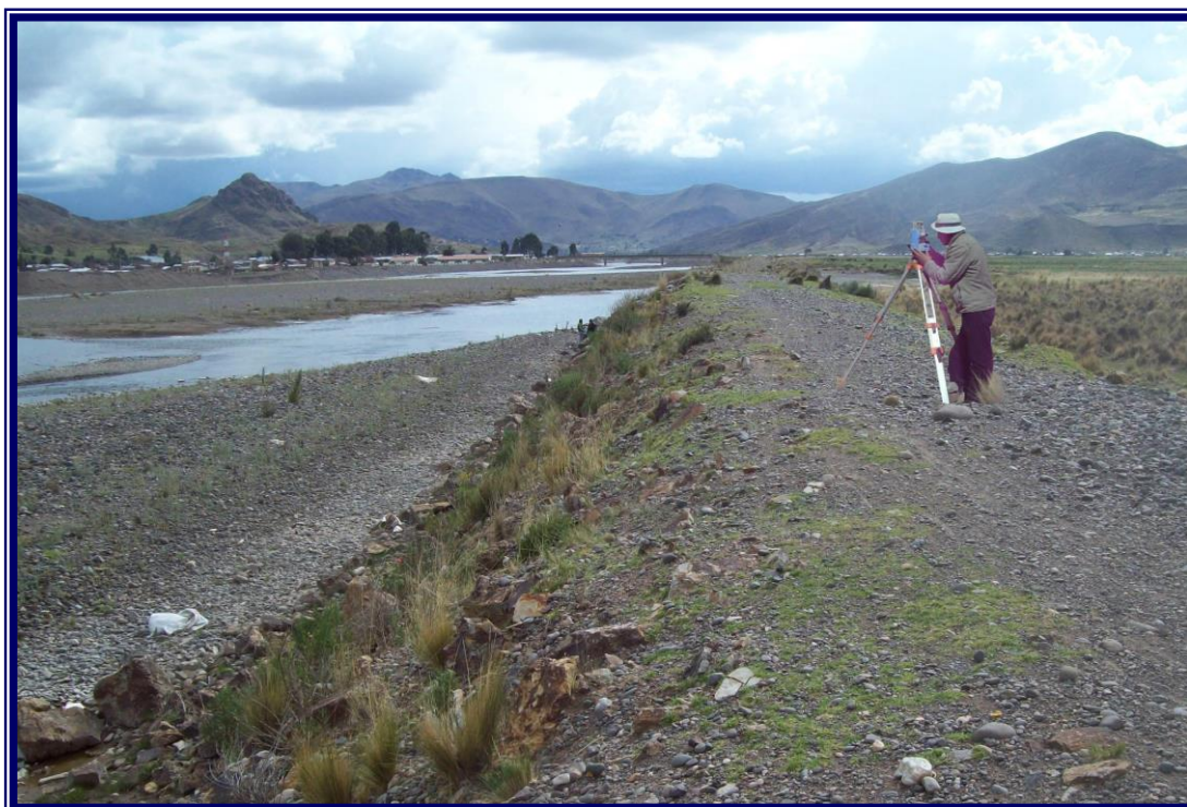
FOTO N°02. LEVANTAMIENTO TOPOGRÁFICO DEL CAUCE NATURAL Y ÁREAS ALEDAÑAS AL RÍO CABANILLAS
