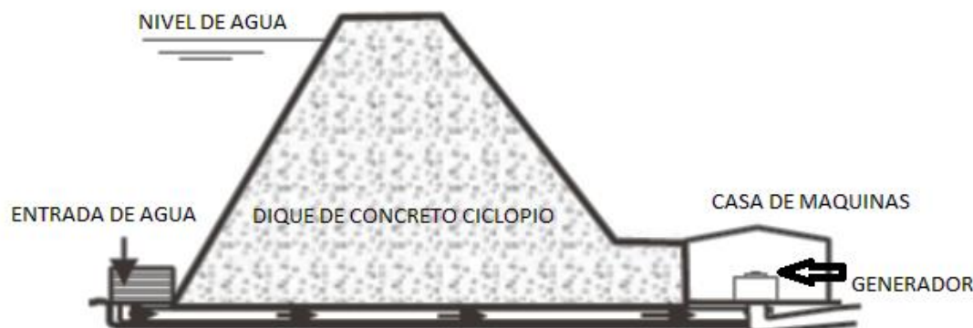
FIGURA 2.3: dique de concreto ciclópeo
