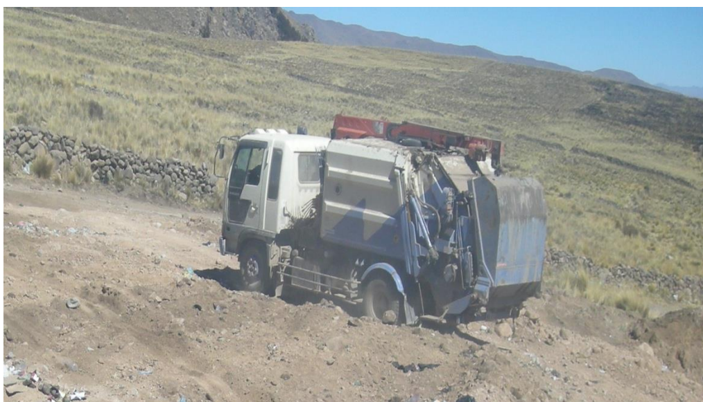
Figura N° 14: Camión compactador 5.5 m 3
