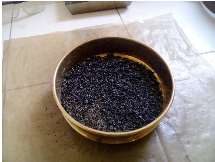
Tamizado del carbón activado de hojas y tallos de Cañihua en malla numero 80
