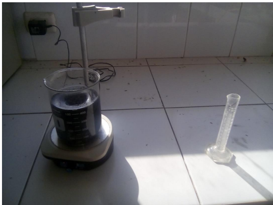
Agitación magnética del carbón activado de hojas y tallos de Cañihua con la solución rica en oro
