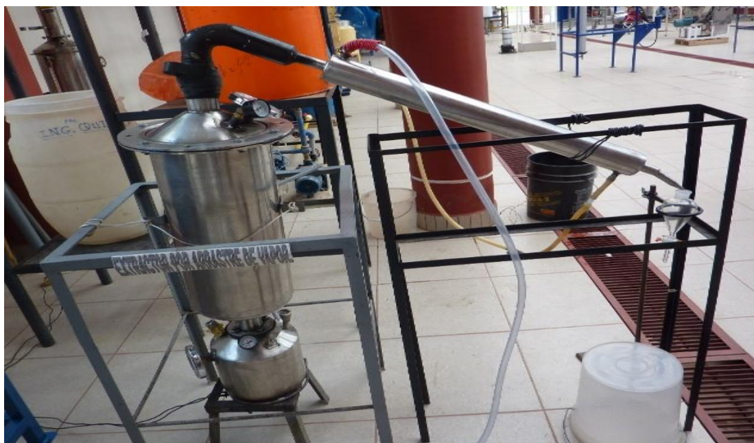
Figura 14. Armado del Equipo de extracción por arrastre de vapor “Super Champion nsda-vs-01 Anoka minn. U.S.A.”
