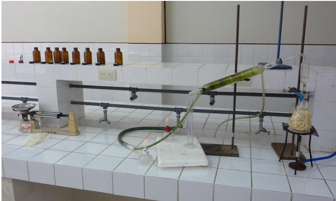
Figura 15. Frascos color ambar, balanza y Equipo de extracción por Hidrodestilación.
