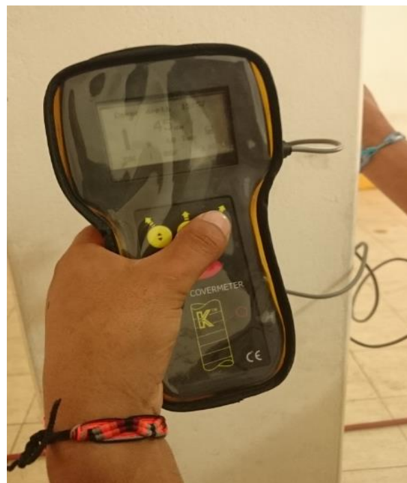
Figura N°15: Lecturas de recubrimiento 45mm Columnas Puno
