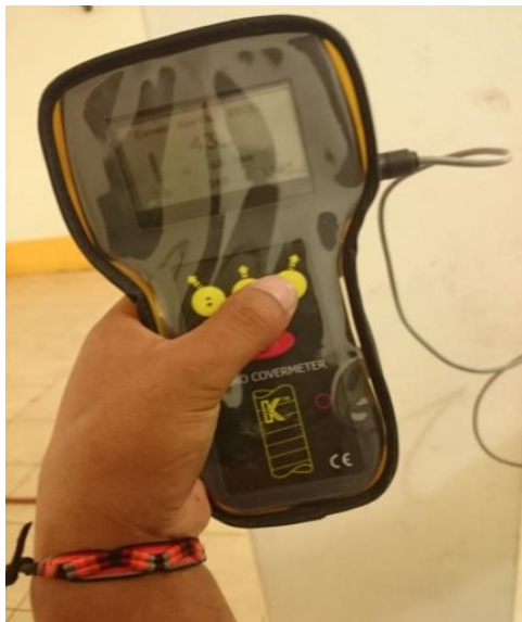
Figura N°12: Lecturas de recubrimiento 43mm Columnas Puno
