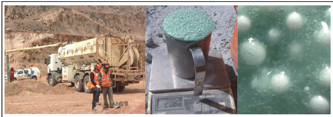
Figura 2. 22 Control de la mezcla Quantex - Toquepala
