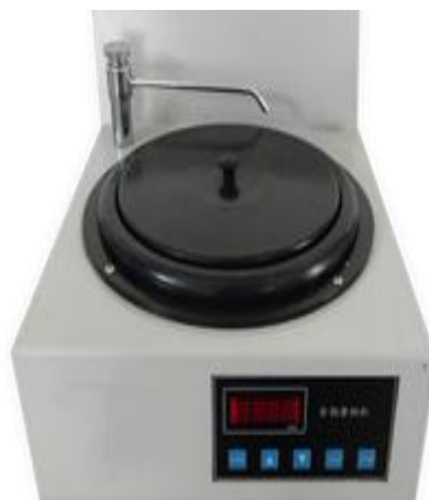
Figura 27: Máquina desbastadora de muestras marca LAP-1.
