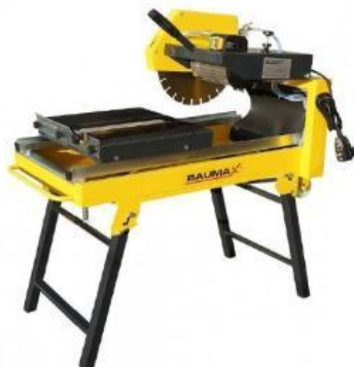
Figura 26: Máquina para cortar y tallar la muestra marca BALIMA.
