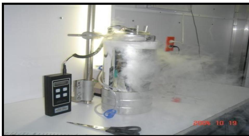
**Figura 8:** Congeladora manual de embriones en proceso de congelamiento a base de nitrógeno líquido.
