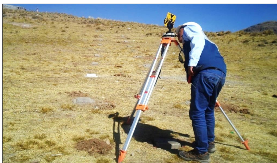
Figura 47. Estacionamiento de tribach con prisma en el punto T-10 para toma de datos. Fuente: Elaboración Propia.
