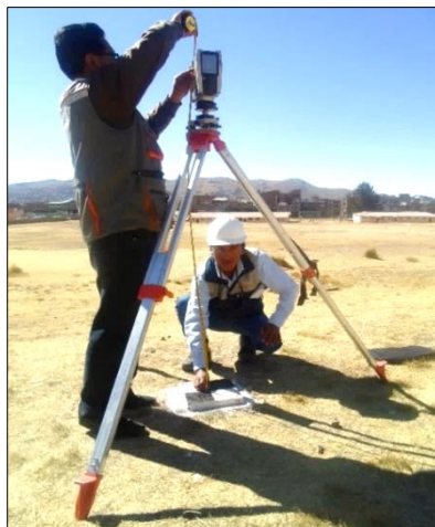
Figura 51. Posicionamiento y medición de altura del equipo escáner láser en el punto ESC. Fuente: Elaboración Propia.
