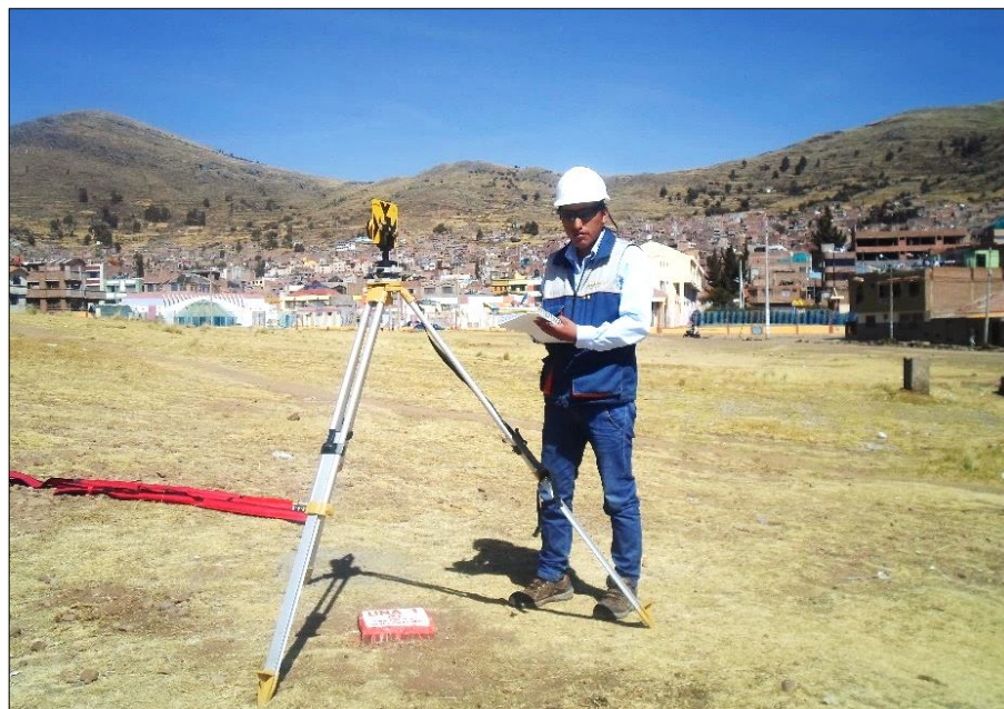
Figura 35. Referencia de azimut y toma de coordenadas para la poligonal. Fuente: Elaboración Propia.
