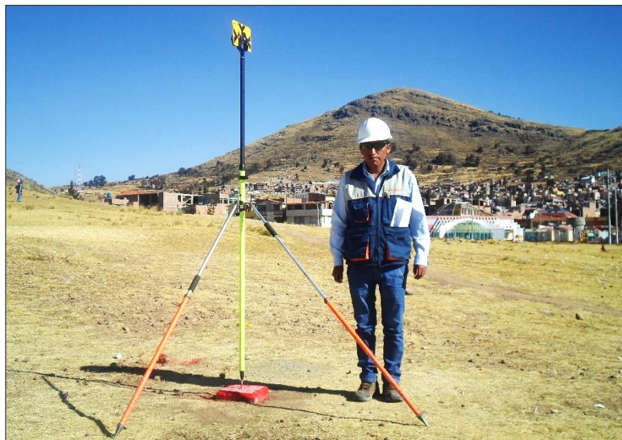
Figura 66. Referencia de azimut al punto UNA-1 con prisma apoyado con bípode. Fuente: Elaboración Propia.
