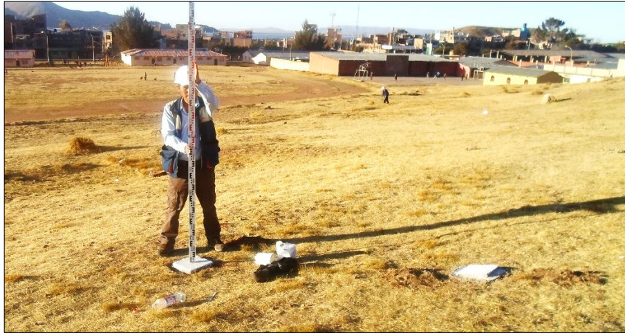
Figura 49. Presentación de la mira en el punto ESC. Para cota de inicio. Fuente: Elaboración Propia.
