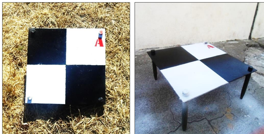
Figura 64. Moldes de metal 22 x 22 cm o llamados targets para la prueba exactitud. Fuente: Elaboración Propia.
