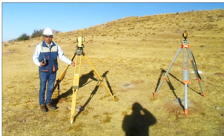
Figura 48. Toma de coordenadas de los puntos T-01 al T-18 sobre los ejes. Fuente: Elaboración Propia.
