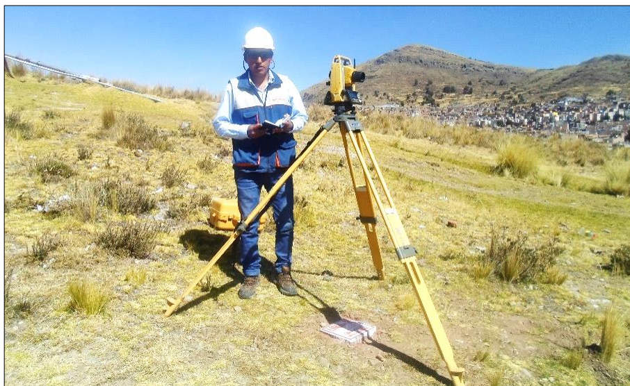
Figura 34. Levantamiento de la poligonal de apoyo con estación total ES-105. Fuente: Elaboración Propia.
