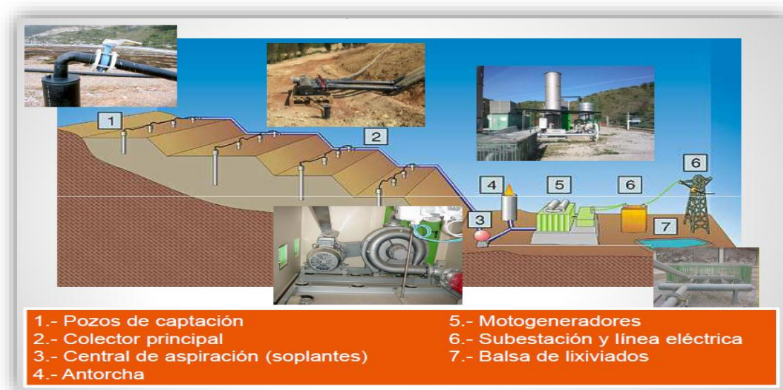
FIGURA 12: Esquema básico de funcionamiento de una central de biomasa
