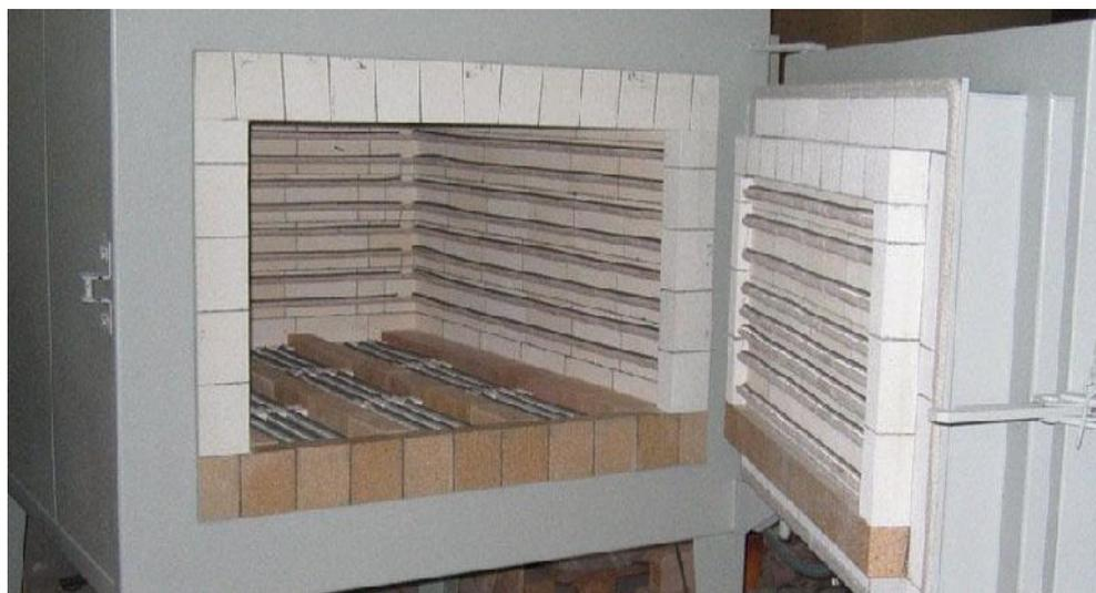
Figura 4: Horno de resistencia eléctrica
