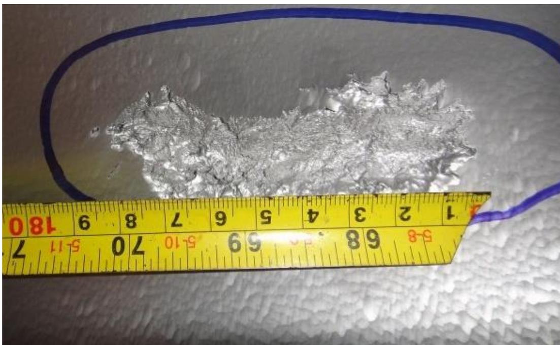
Figura 1: Cavitación de Cangilones en la turbina Pelton
