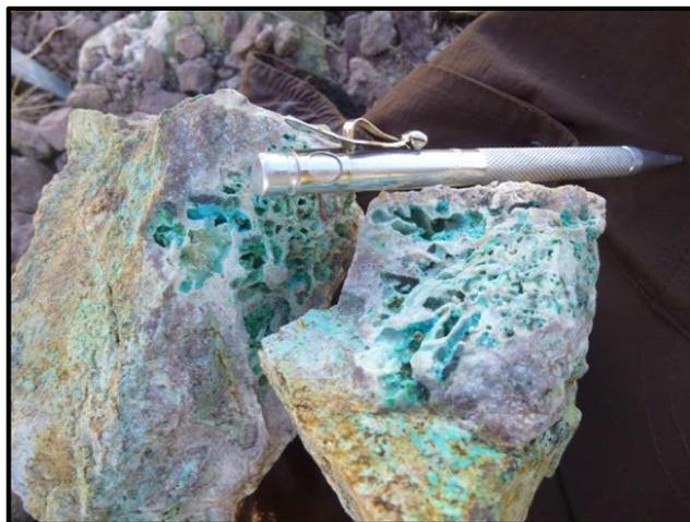
**Figura 29:** Mineralización de cobre en estructura vetiforme, presenta porosidad rellena de malaquita.
