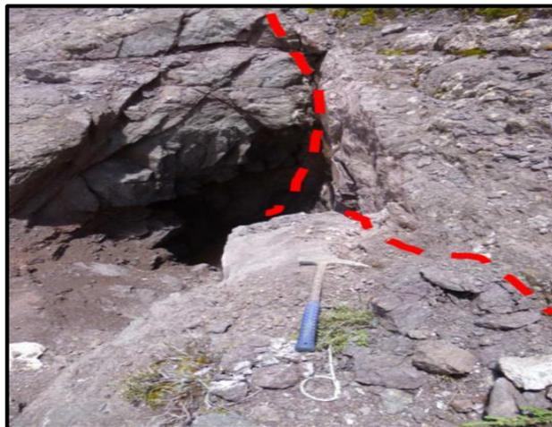
**Figura 28:** Veta 2 rellena en Fractura de espesor 5 cm; se observa un pique de 3 m. de profundidad.
