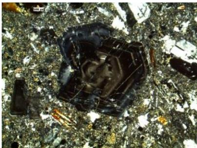
**Fotomicrografía 5. (NX):** Cristal de plagioclasa mostrando líneas de inter crecimiento y estructura zonad. 40X.
