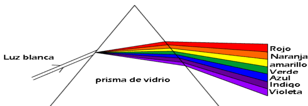
FIGURA 14. INCIDENCIA DE LA LUZ BLANCA SOBRE UN CRISTAL Fuente: https://www.emaze.com/@ALZWFLFR/La-luz-6%C2%B0-B
