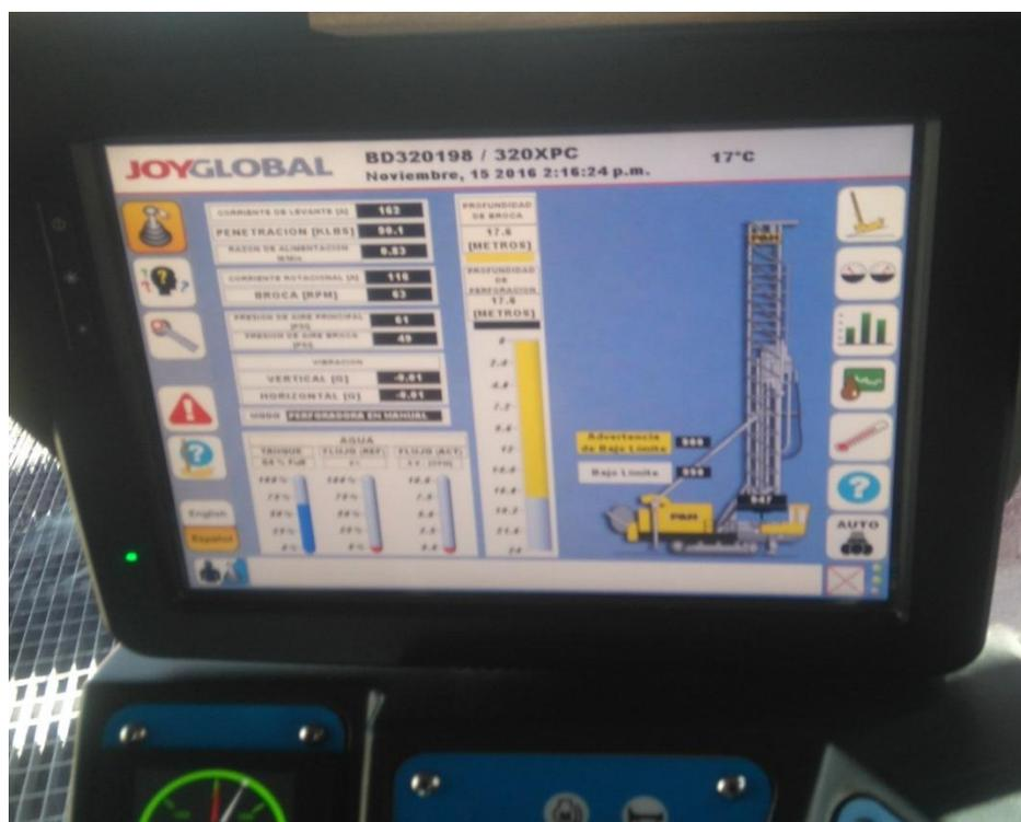
**Figura 4.3.** Pantalla de estado, indicando los valores de perforación por taladro.
