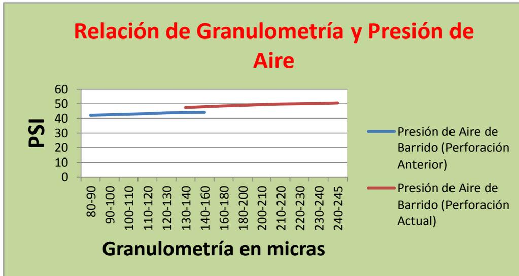
**Figura 4.4.** Relación de presión de aire con granulometría del detritus de perforación.
