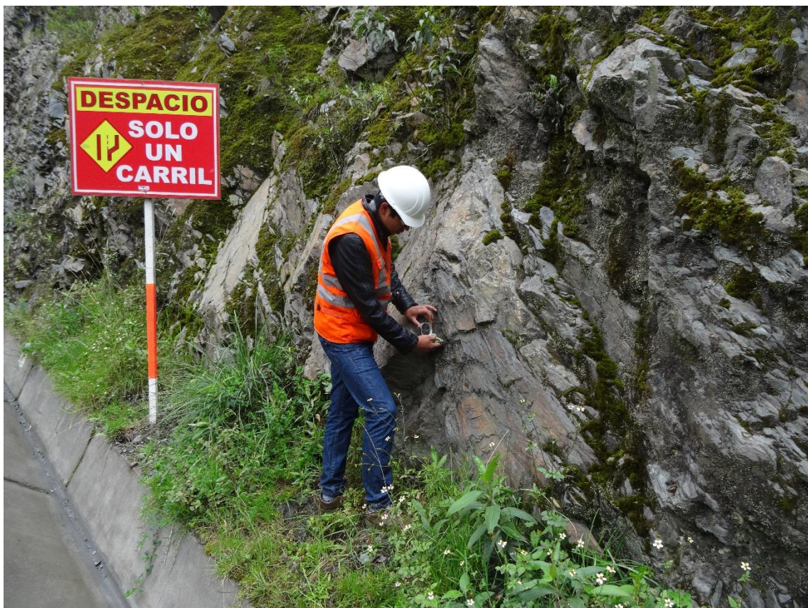
Figura C. 6. Mapeo geomecánico con brújula Brunton GEO en el sub talud 10
