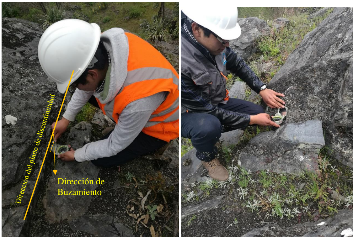
Figura C. 17. Mapeo geomecánico con brújula en la zona alta del talud
