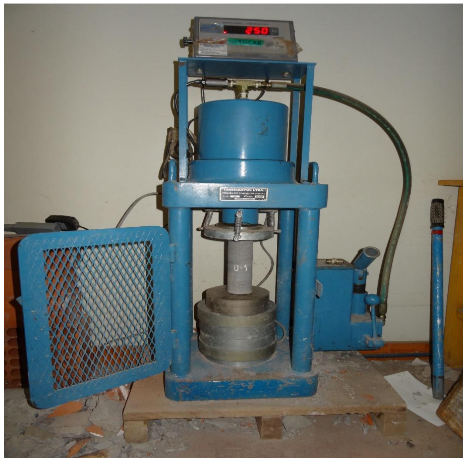
Figura C. 28. Testigos extraídos para el ensayo de compresión simple y Tilt Test
