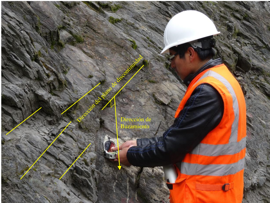
Figura C. 6. Mapeo geomecánico con brújula Brunton GEO en el sub talud 10
