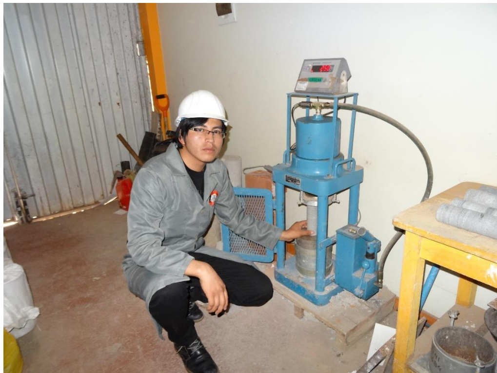
Figura C. 27. Ensayo de compresión simple de la roca intacta
