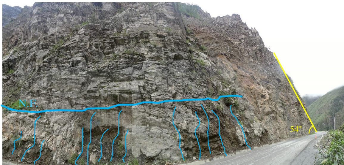
Figura C. 8. Macizo rocoso sub talud 6, familias de discontinuidades
