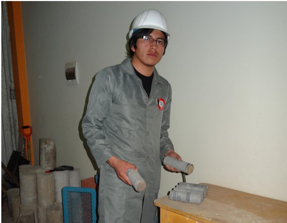
Figura C. 26. Testigos de roca para Ensayo de Compresión Simple y Tilt Test
