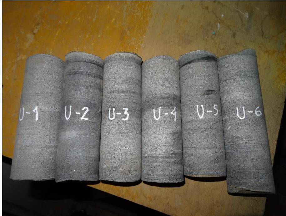
Figura C. 28. Testigos extraídos para el ensayo de compresión simple y Tilt Test
