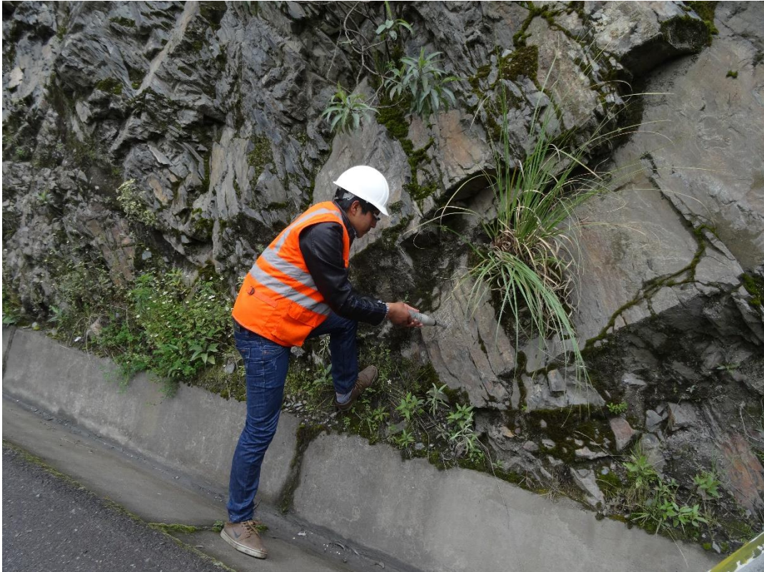
Figura C. 4. Determinación del UCS con el martillo Schmidt
