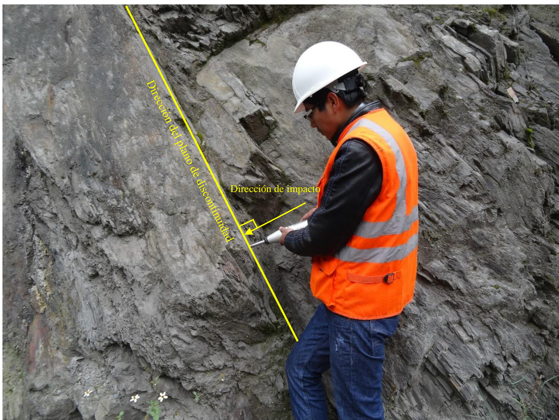
Figura C. 4. Determinación del UCS con el martillo Schmidt
