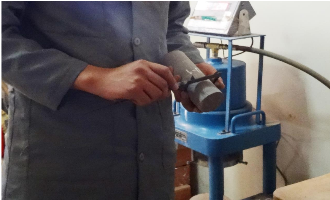
Figura C. 30. Medición de las dimensiones del testigo con el vernier
