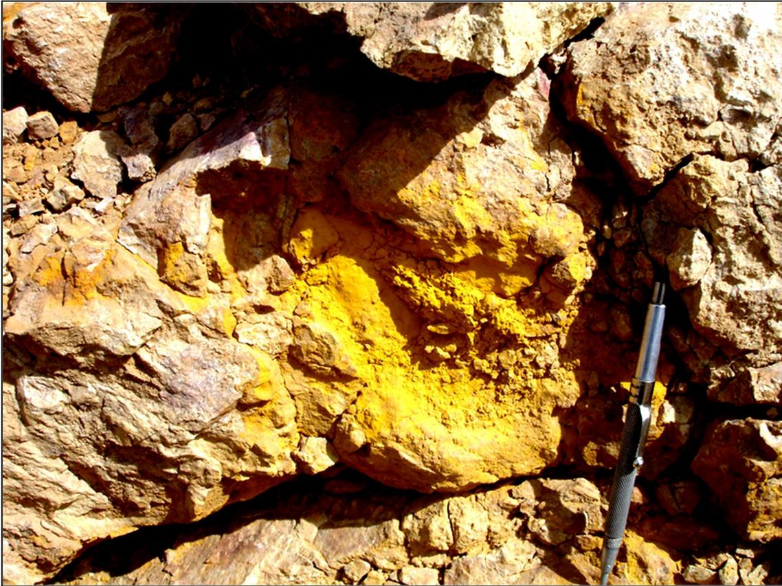
Figura 10 Abundante jarosita impregnada sobre roca silicificada – alunita
