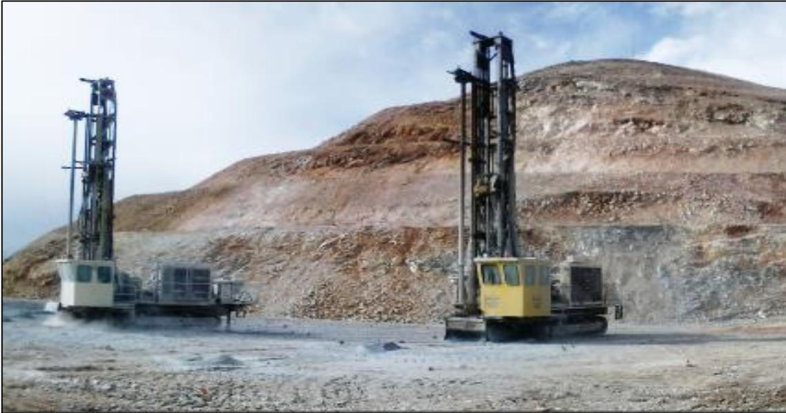
**Figura 12. Perforadoras DM45**
