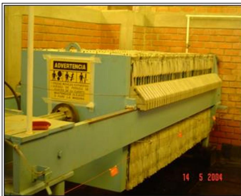
Figura 20. Equipo de recuperación de precipitados
