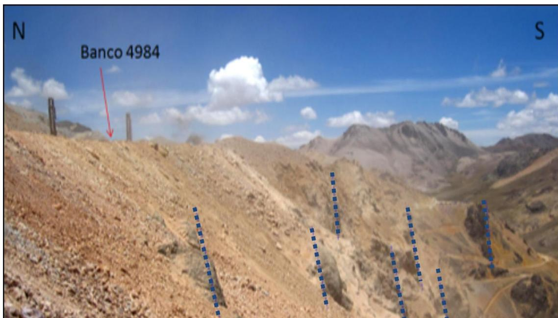
Figura 6 Control estructural de Jessica tendencia E-W - N70°E.
