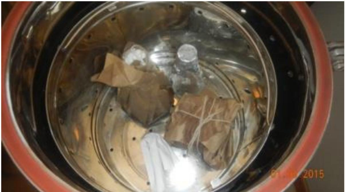
Figura 11. Autoclavado de materiales : Para no tener ningún tipo de contaminación al momento de realizar los cultivos y observaciones al microscopio necesitamos esterilizar los materiales a ser utilizados.
