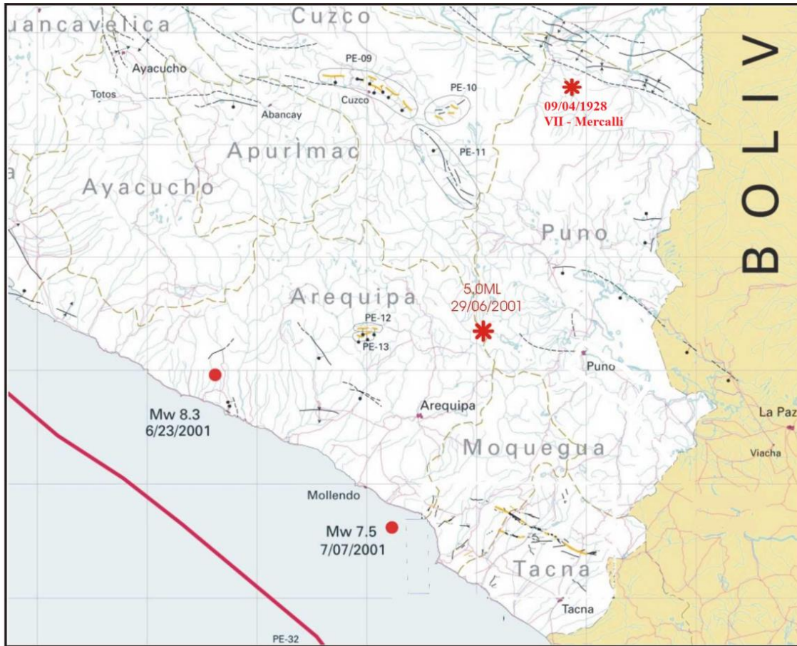
Figura 4: Principales sistemas de fallas del Cuaternario presentes en la región sur del Perú. Los puntos en rojo indican los epicentros de los sismos más grandes ocurridos en los últimos 100 años. Las trazas en interlineado indican la ubicación y dimensiones de las fallas presentes, los importantes lineamientos identificados podrían haber dado origen al sismo de Carabaya de 1928. (Alva Hurtado J; E. Meneses J; Guzmán V. (1984).
