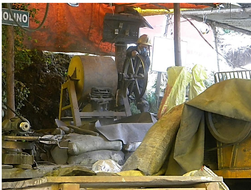
Figura 21. Proceso molienda del MT, desarrollado en la Comunidad Minera de Ollachea, Agosto a Octubre del 2017.
