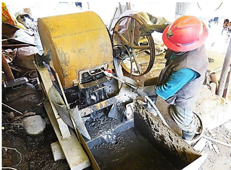
Figura 15. Proceso molienda del ME, desarrollado en la Comunidad Minera de Ollachea, Agosto a Octubre del 2017.
