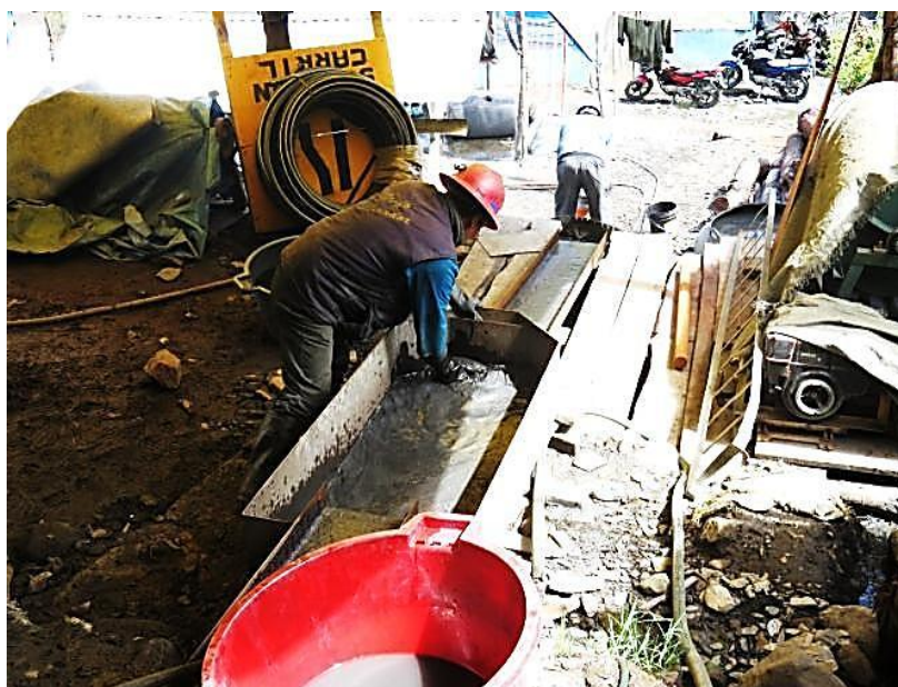
Figura 16. Proceso deslame del ME, desarrollado en la Comunidad Minera de Ollachea, Agosto a Octubre del 2017.
