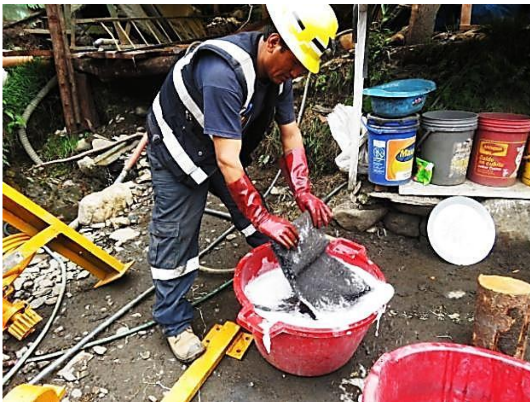
Figura 17. Proceso lavado de alfombra filtro del ME, desarrollado en la Comunidad Minera de Ollachea, Agosto a Octubre del 2017.
