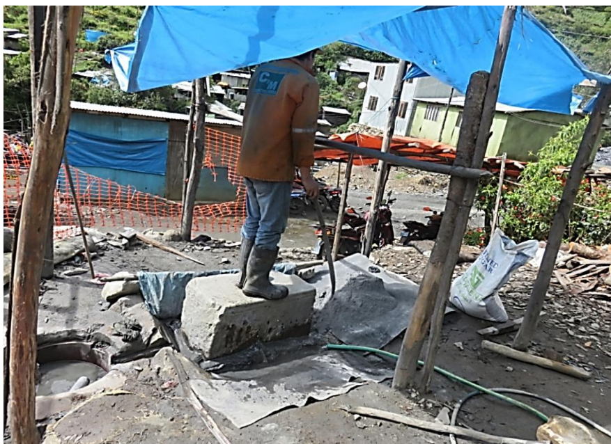
Figura 22. Proceso Quimbalete del MT, desarrollado en la Comunidad Minera de Ollachea, Agosto a Octubre del 2017.
