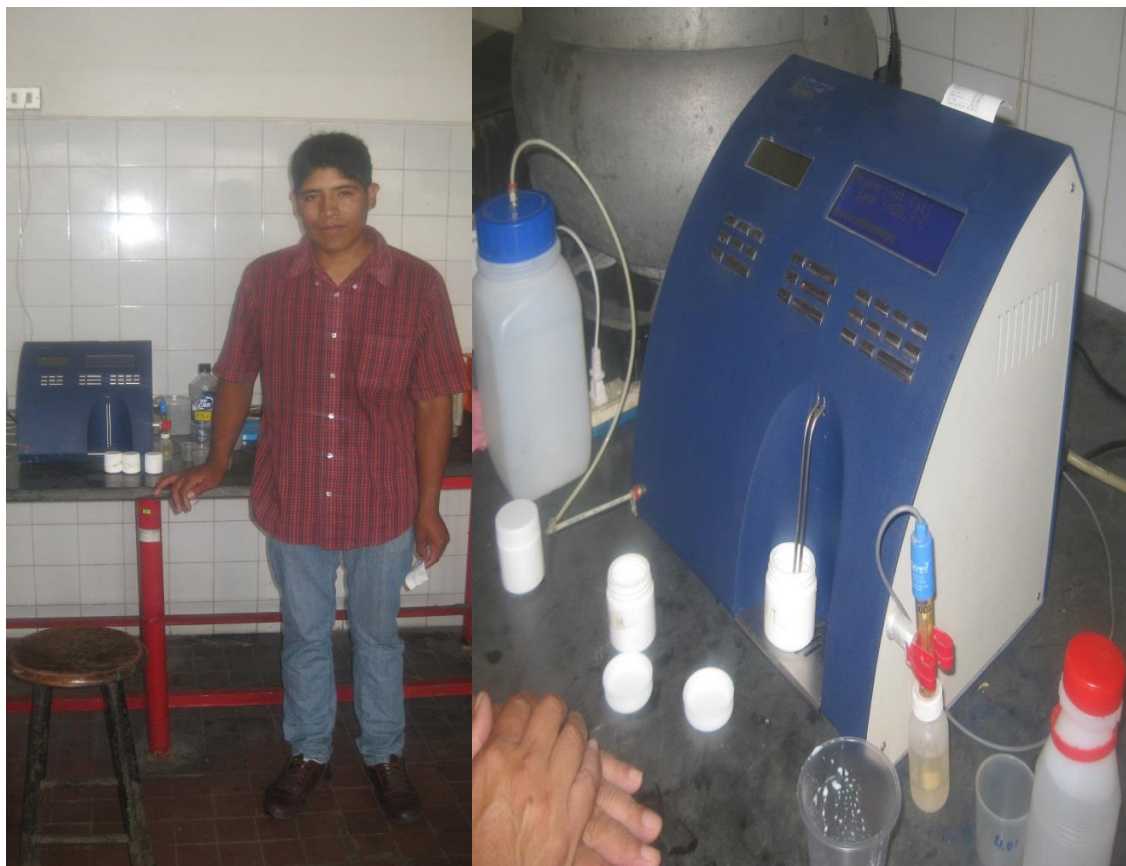
Foto 10. Equipo Analizador de leche por ultrasonido: Milkoskope julie Z7
