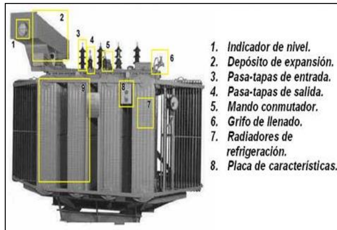
Figura 1: Transformador de Potencia sumergido en aceite.
