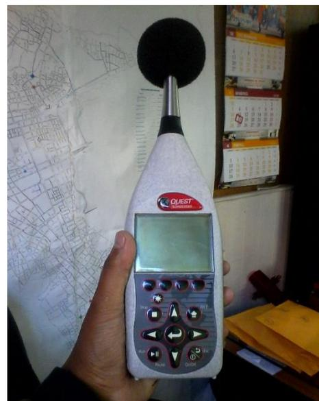
**Figura 8:** Sonómetro y calibrador para la toma de datos
