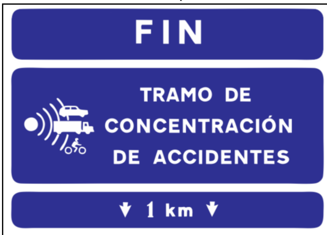
Figura 39. Señalización de TCAs (Fin: tramo de concentración de accidentes) Fuente: Propia
