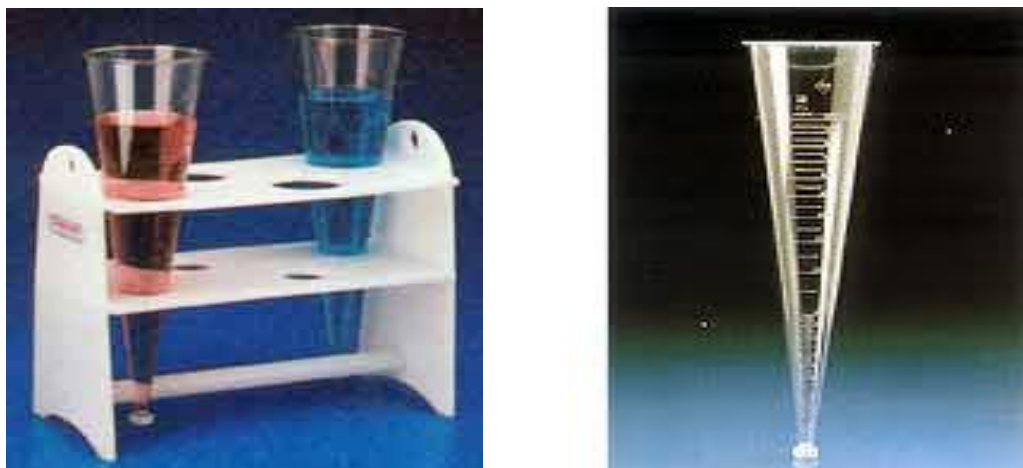
Figura 7. Conos Inhoff utilizados para determinar la velocidad de sedimentación
