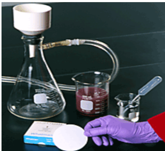
Figura 8. Sistema de filtrado a presión de vacío
