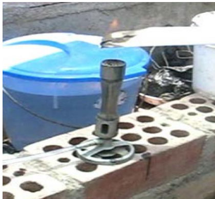
Figura 17. Prueba de ignición del biogás producido
