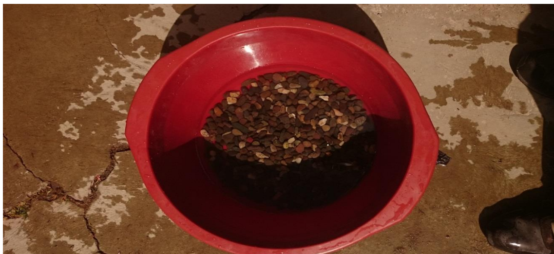
Figura 7 Lavado de la grava
