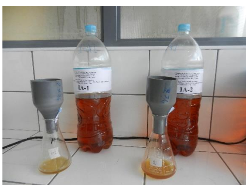
FIGURA 12 Filtrado de muestras de aceites vegetales usados en 21 pollerías de la ciudad de Juliaca
