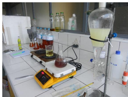
FIGURA 21 Lavado del biodiesel producido
