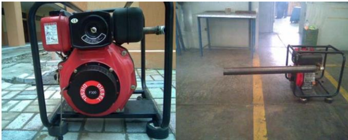
FIGURA 24 Prueba de efectividad del biodiesel en un motor convencional.
