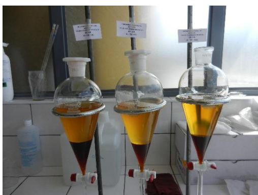
FIGURA 19 Proceso de separación de la glicerina y biodiesel producido luego del proceso de transesterificación.
