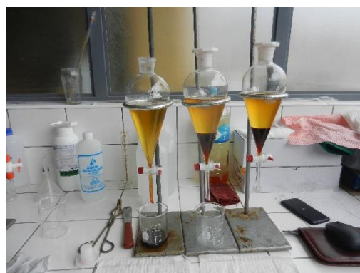
FIGURA 20 Extrayendo la glicerina luego de la decantación en el tubo de decantación luego del proceso de transesterificación.
