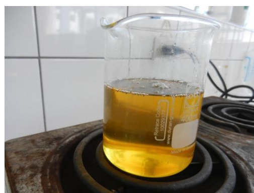
FIGURA 22 Deshidratado del biodiesel producido
