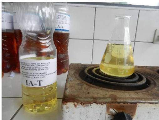
FIGURA 17 Calentando el aceite para evaporar el agua del AVU.
