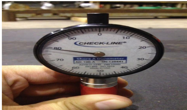
Figura N° 18: Instrumento de Medición Durómetro. (Manual técnicas de ejecución de Empalmes TTM Chile)
