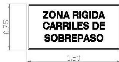
**Figura 22.** Aviso para la zona rígida antes y después de los carriles de sobrepaso
