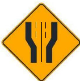
*Figura 18. P-21 Señal preventiva de ensanchamiento de calzada a ambos lados*
