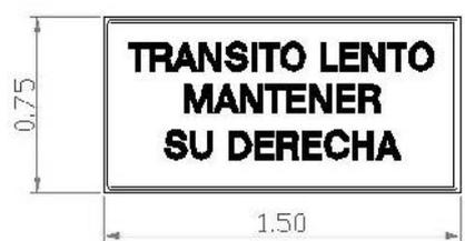
**Figura 24.** Aviso para el flujo vehicular en la zona de los carriles de sobrepaso.
