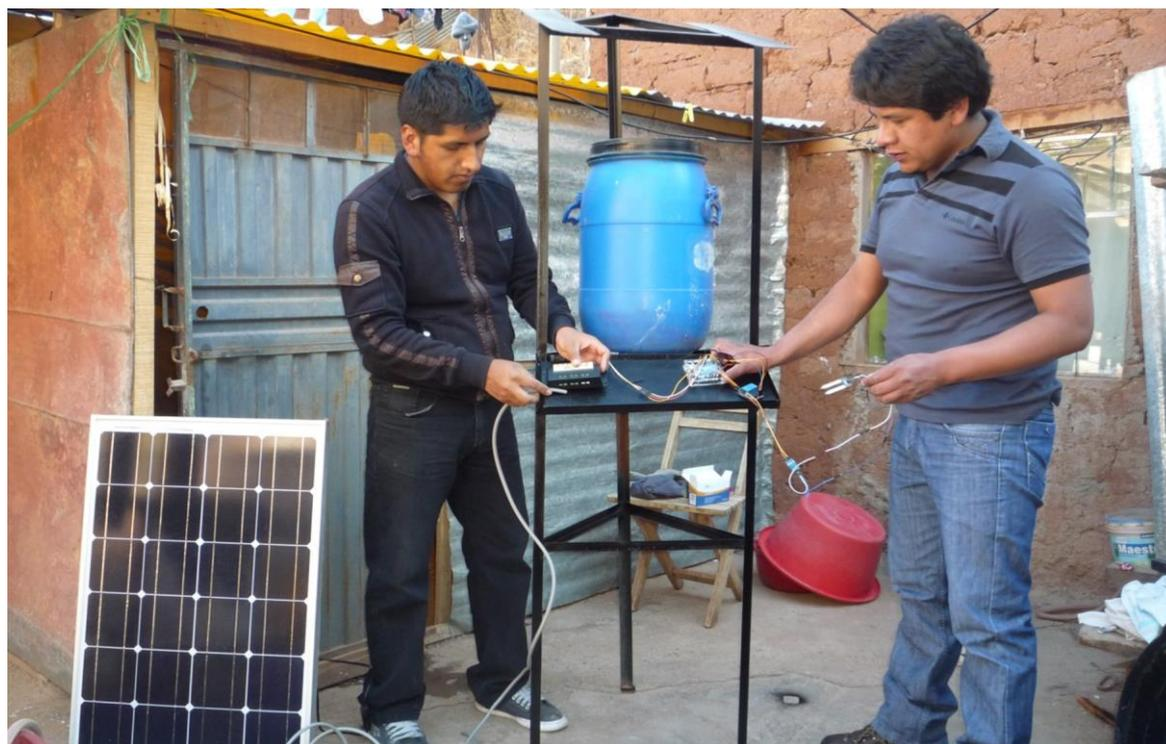
**Fotográfica N° 09:** visualización de armado de prototipo automatizado para riego con sistema Arduino y paneles fotovoltaicos.
