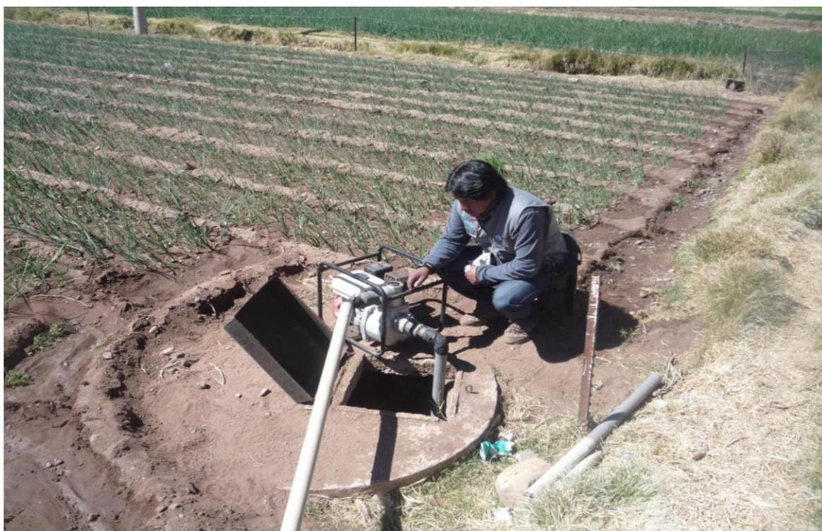
**Fotográfica N° 05:** Se observa el uso de bombas a combustible en el sistema de riego por inundación en parcelas.
