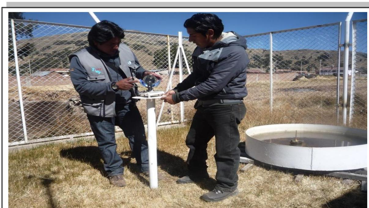
**Fotográfica N° 02:** Heliógrafo equipo de lectura de horas de sol en la estación Ichu de propiedad del PELT.
