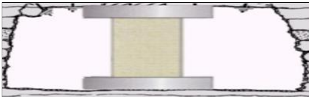
Figura N° 2.5: Interacción de cámara y gata.
