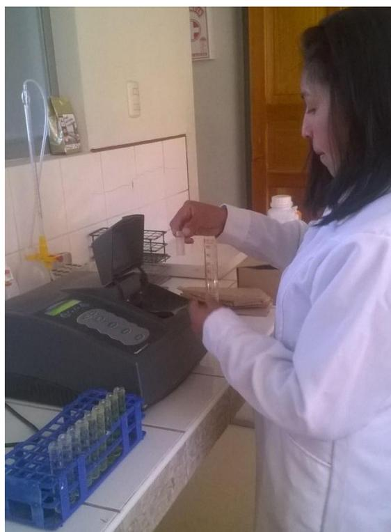
**FIGURA 06. LECTURA DE LA ADSORBANCIA PARA EL PROCESO DE REMOCIÓN DEL CLORO RESIDUAL**
