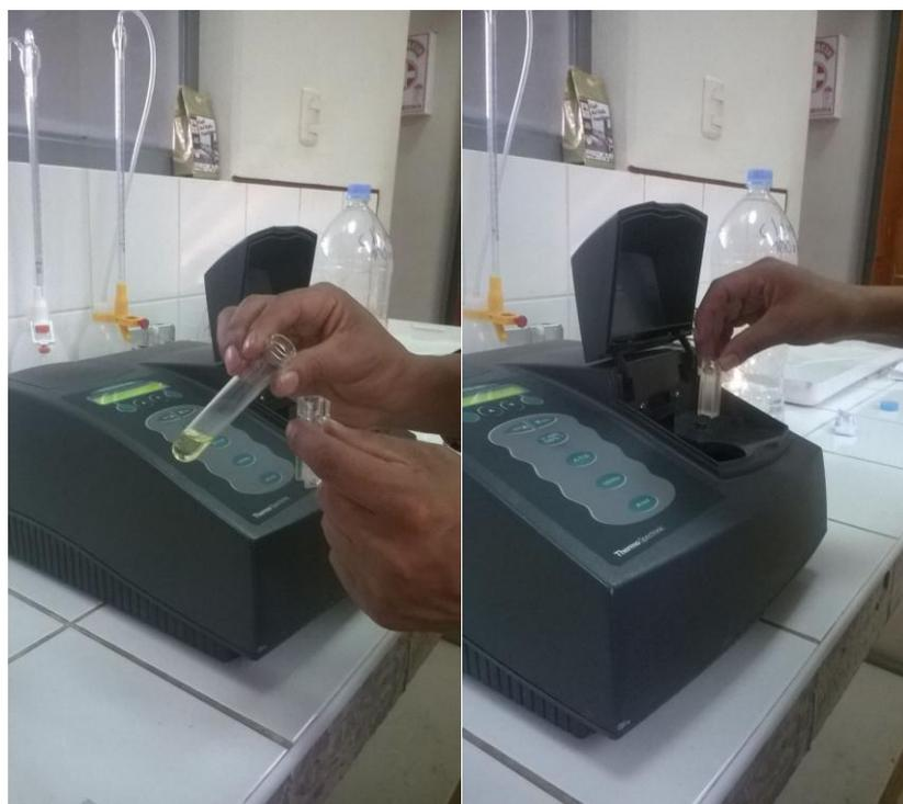
**FIGURA 04. LECTURA DEL ESPECTROFÓTOMÉTRICO PARA LA ELABORACIÓN DE LA CURVA DE CALIBRACIÓN**
