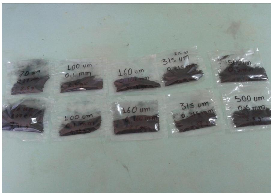
FIGURA 02. CARBON ACTIVADO ELABORADO CON MATERIA PRIMA LENTEJA DE AGUA A DIFERENTES TAMAÑOS DE PARTICULA
