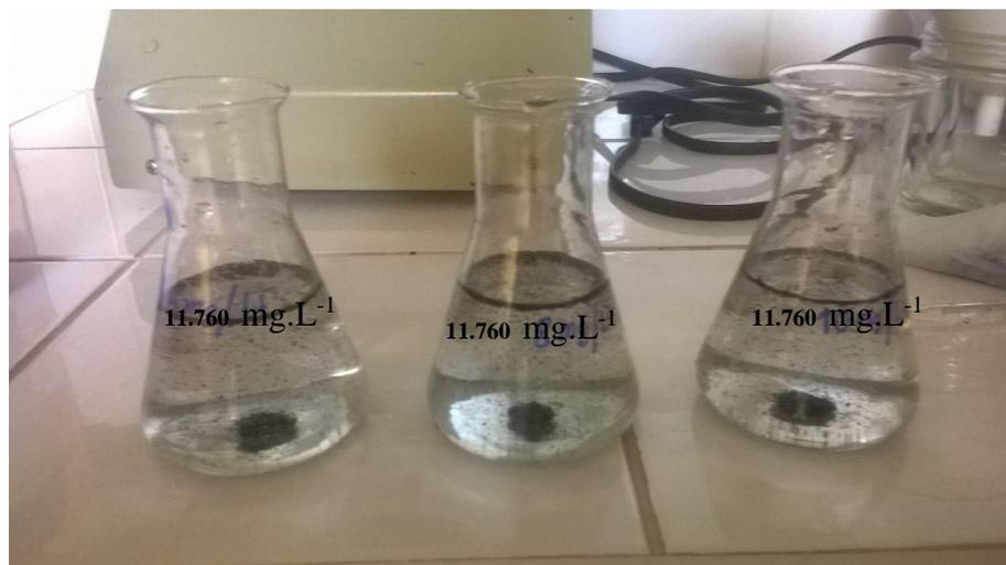
**FIGURA 05. CONCENTRACIÓN DE CLORO RESIDUAL EN MATRACES AFORADOS CON LOS RESPECTIVOS PESOS DE CARBÓN Y TAMAÑO DE PARTÍCULA**
