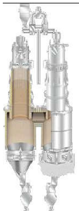
Figura 6. Horno Maerz PFR Para Grano Fino
