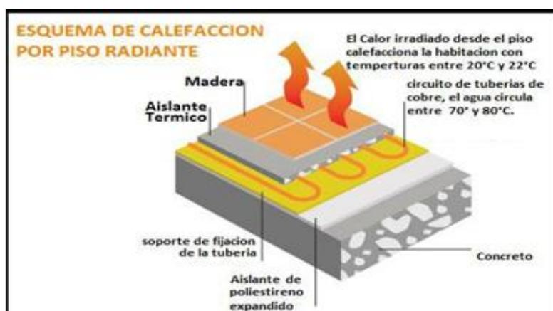
Figura 74: Piso radiante, Corte
