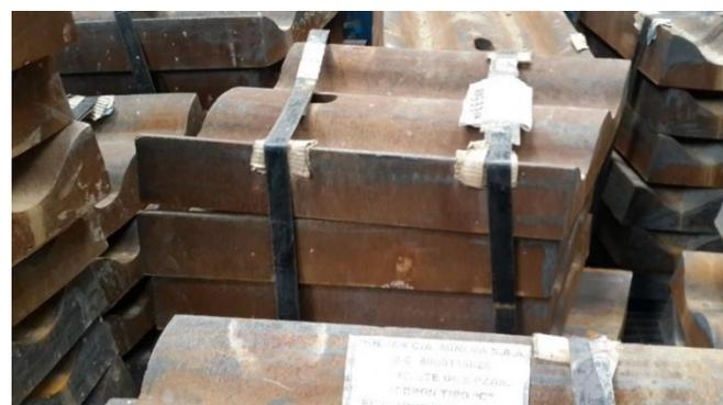
Figura 21. Forros de acero nuevos para revestimiento
