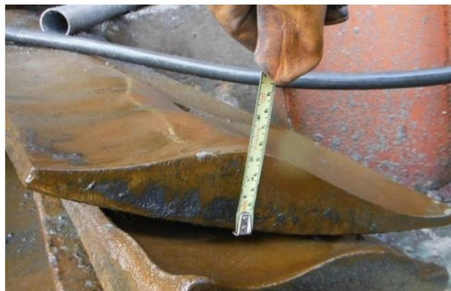
Figura 20. Forro de acero desgastado
