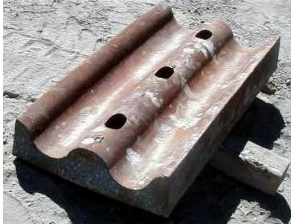
Figura 9. Forro de Doble Onda – 120 kg
