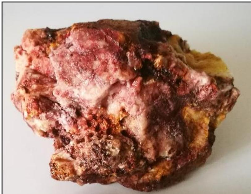
**FOTOGRAFÍA N° 09.** Muestra de mano de una de las estructuras mineralizadas, se encuentra dominado por halos de Cuarzo (QZ) en forma de bandas y rodeado por Óxidos de Hierro (OxFe), y oro libre en las cavidades, (*fente propia*).
