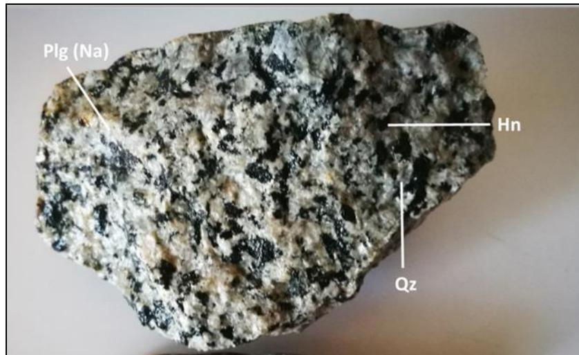
**FOTOGRAFÍA N° 07.** Muestra de mano de composición Diorítica, extraída de sectores con altas anomalías metálicas, esencialmente Au el contenido principalmente de Cuarzo (Qz), (*fuentes propia*).
