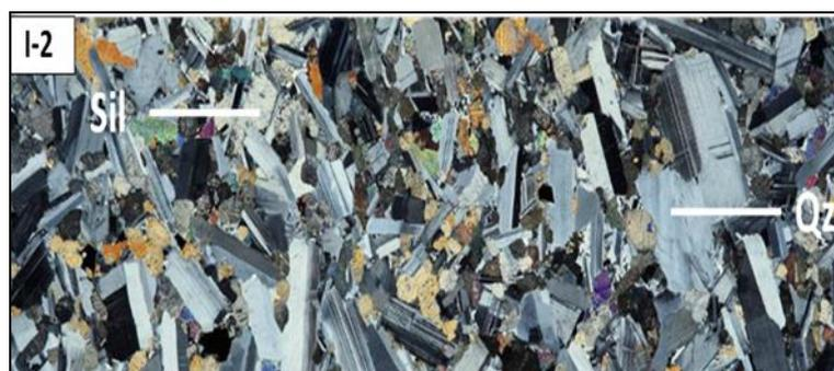
**FOTOGRAFÍA N° 12, I-2;** Lámina delgada de una muestra de composición Diorítica, vista al microscópico, donde se puede diferenciar claramente que la muestra posee contenidos superiores de feldespatos y muy pobre en composición de cuarzo y sílice (*Fuente E.M.M.E.I.R.Ltda*)..
