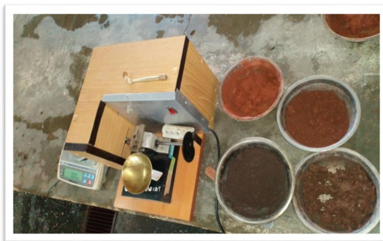
Figura 30: Ensayo de LL para las dosificaciones de ceniza volante y cal 5% (cte.)
