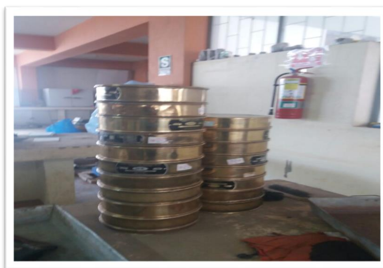
Figura 23: Ensayo de Análisis Granulométrico por Tamizado
