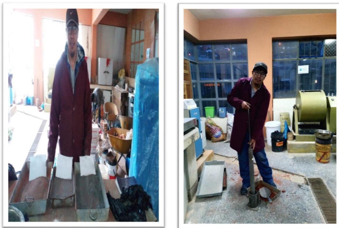
Figura 34: Combinación de Suelo, C.V. y Cal 5% (cte) para la compactación de la muestra
