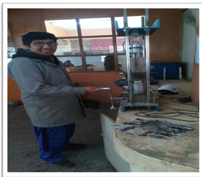
Figura 37: Ensayo de CBR
