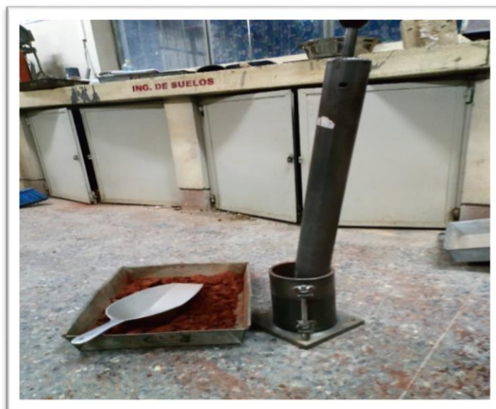
Figura 26: Equipo para el Ensayo Proctor
