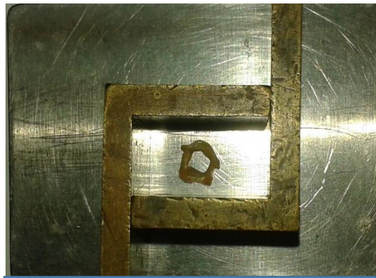
Posicionamiento de la muestra dentro de los ángulos metálicos.
