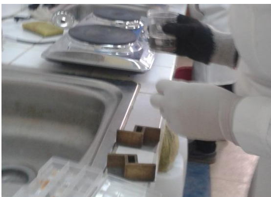
Encofrado y vertido con parafina.
