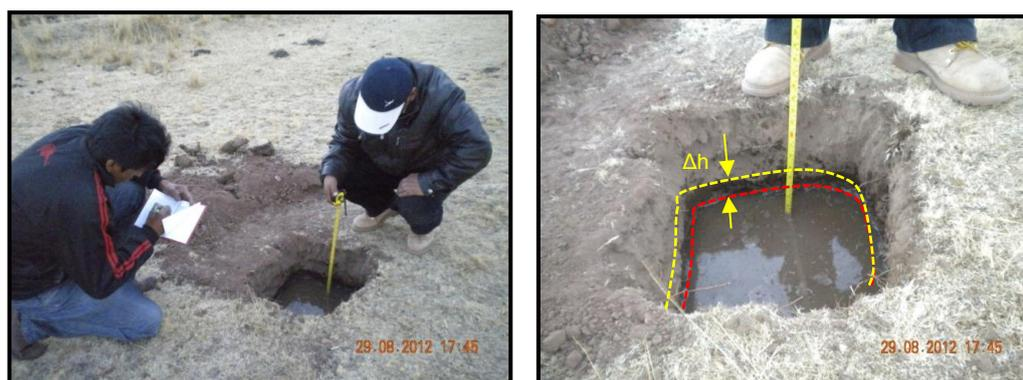
Figura 4.14. Ensayo de permeabilidad en calicatas.
