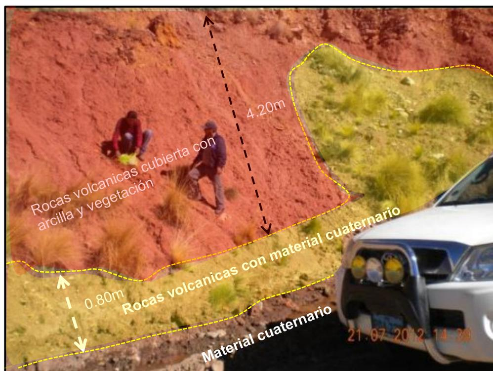
Figura 3.29. Esquema de la estratigrafía aguas abajo dique inferior.
