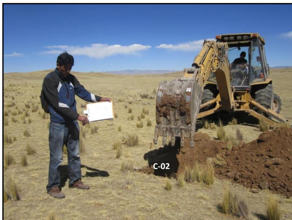
**Figura 4.5.** C-02, con bastante infiltración en el eje del Dique Superior profundidad de calicata 4.50m. NF=1.70m suelo material Orgánico, y material arcilloso con presencia de limo y roca tritura muy fina.
