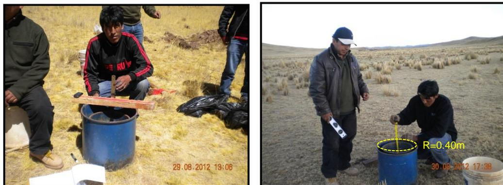
Figura 4.13. Ensayo de infiltrómetro en el vaso.
