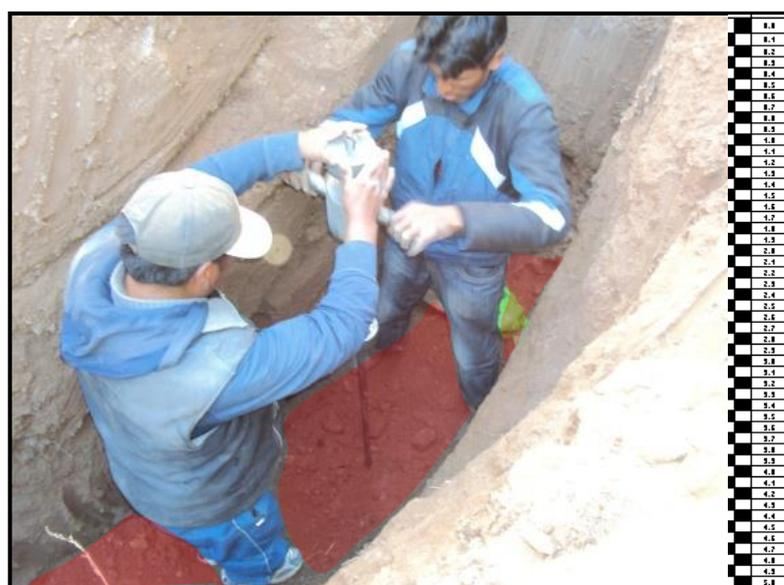
Figura 4.32. Proceso de penetración con DPL en la calicata C-08.
