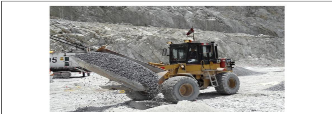
Figura 2.15. Cargador frontal de volteo lateral. Fuente. Instituto de Ingenieros de Minas-17 Convención minera
