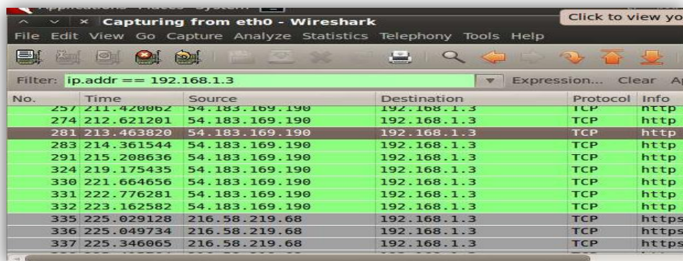
Figura N°14 Re direccionamiento del tráfico hacia la maquina atacante
