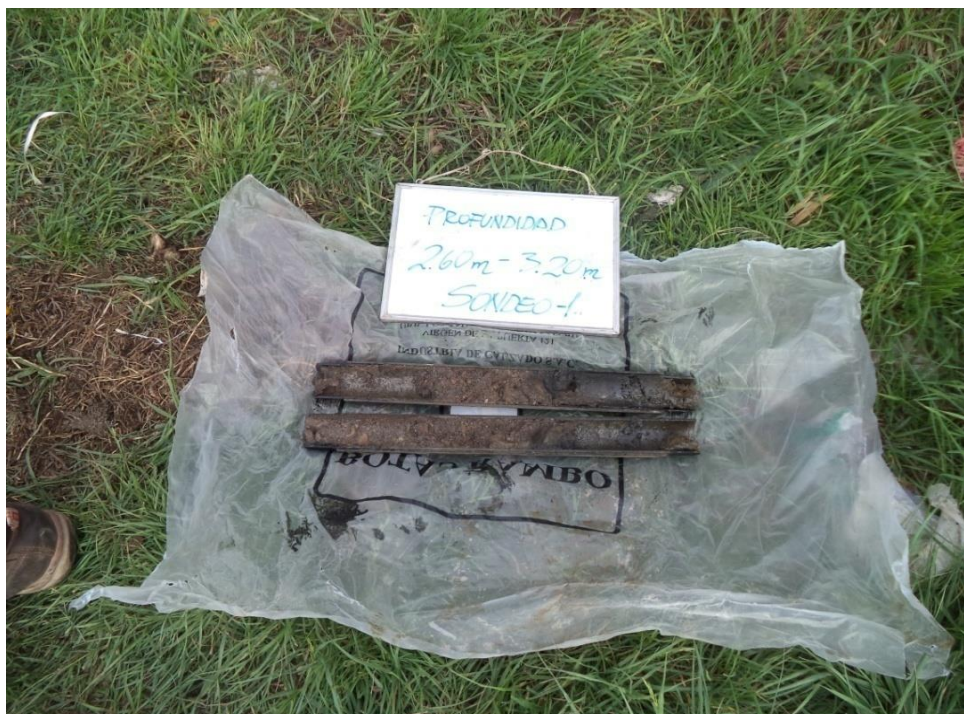
IMAGEN 11: Toma de Muestra Sondeo 1 a la Profundidad de 2.60-3.20m.
