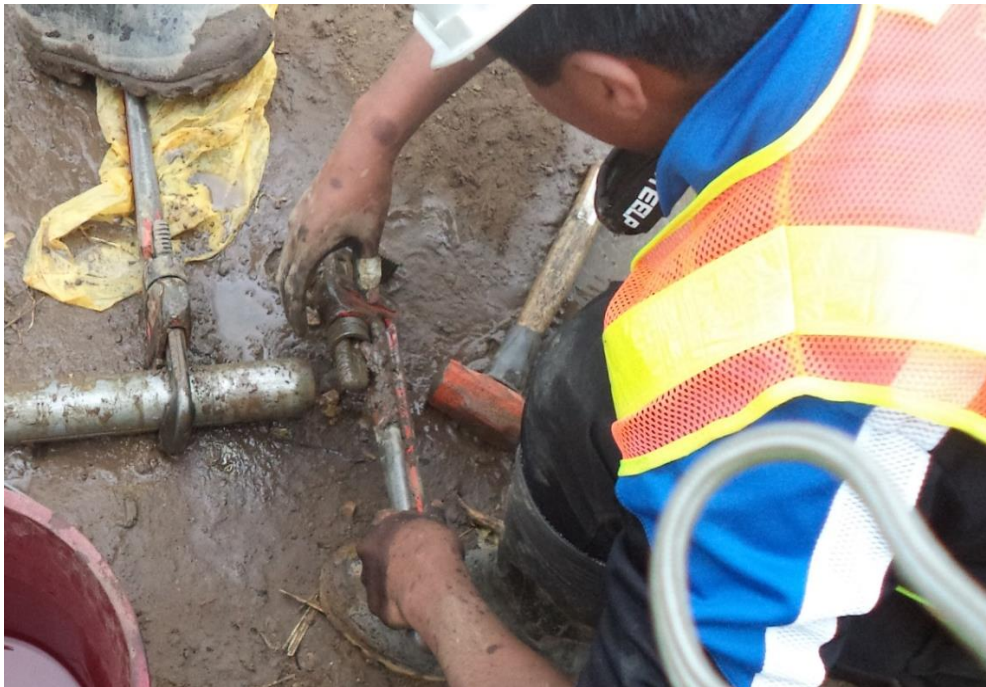
IMAGEN 14: Vista de Muestreador de Caña partida con la muestra de suelo en su interior, FUENTE: Elaboración propia.
