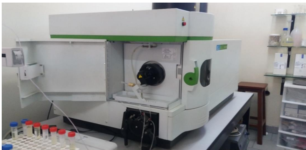
Figura 10: Equipo de laboratorio para la determinación de metales pesados por el método de Espectrometría de Emisión Atómica de la UCSM - Arequipa.
