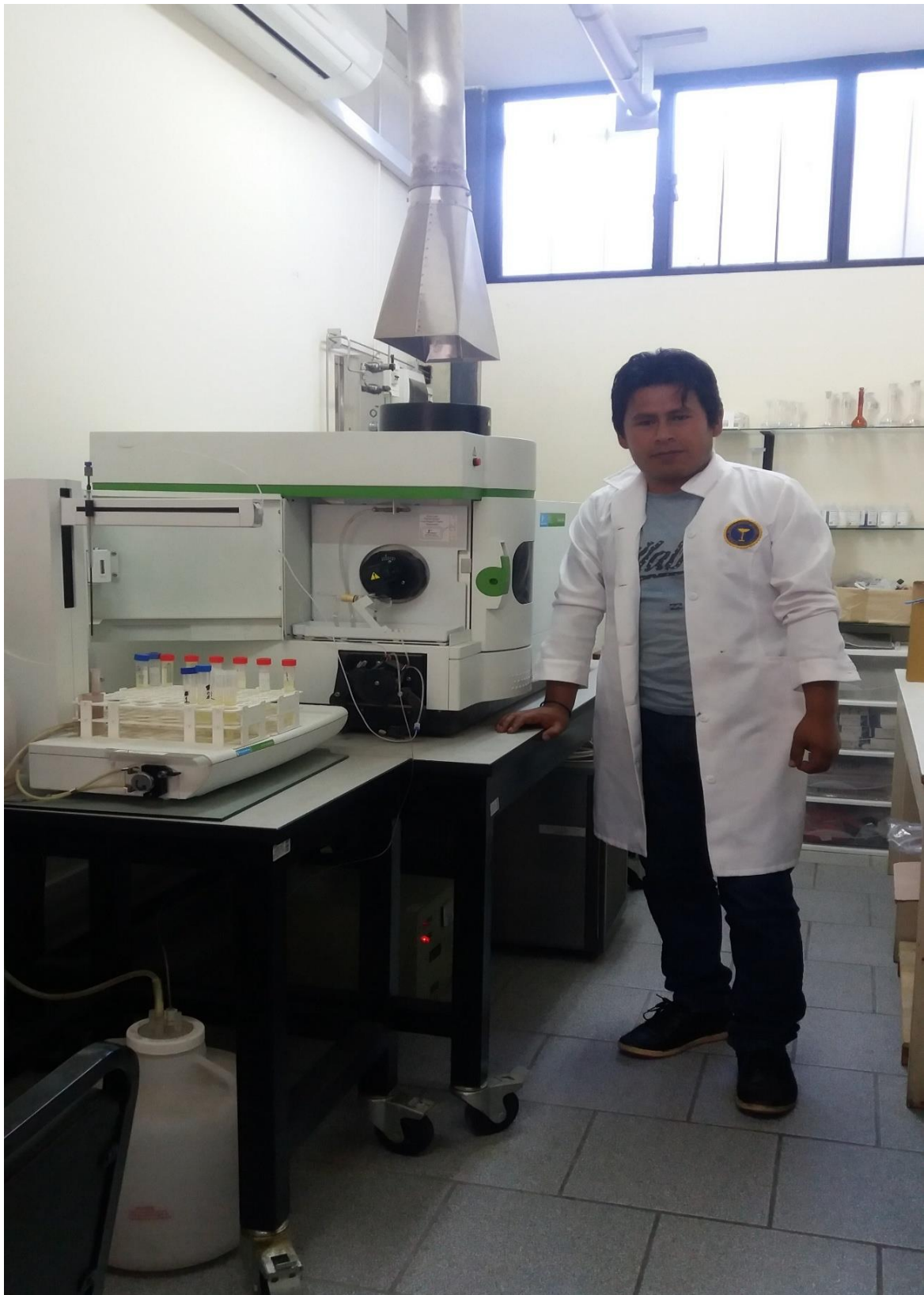
Figura 29: Equipo de Espectrometría de Emisión Atómica (Determinación de metales totales).
