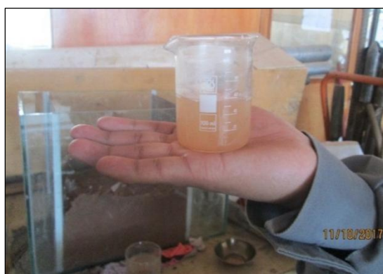
Figura 28. Medición del drenaje del líquido después del proceso de electroósmosis Fuente: Elaboración propia
