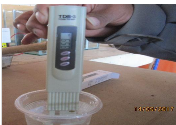
Figura 22. Medición de la conductividad eléctrica del líquido Fuente: Elaboración propia
