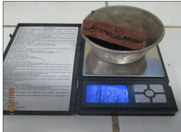
Figura 49. Peso de la muestra con falla pre electroósmosis Fuente: Elaboración propia
