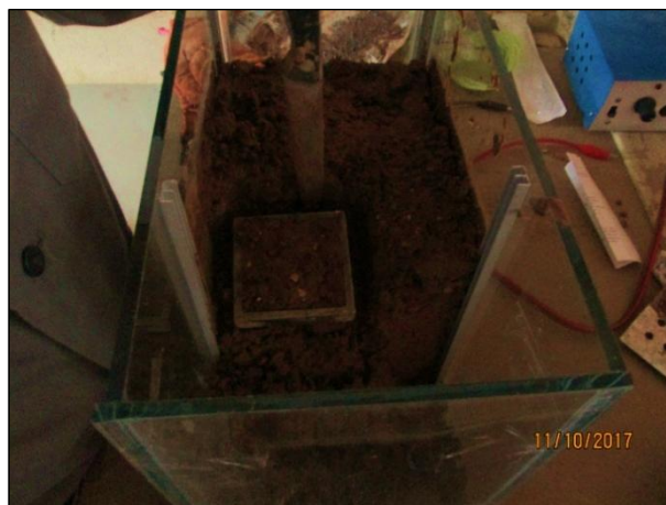
Figura 45. Tallado de la muestra pos electroósmosis Fuente: Elaboración propia
