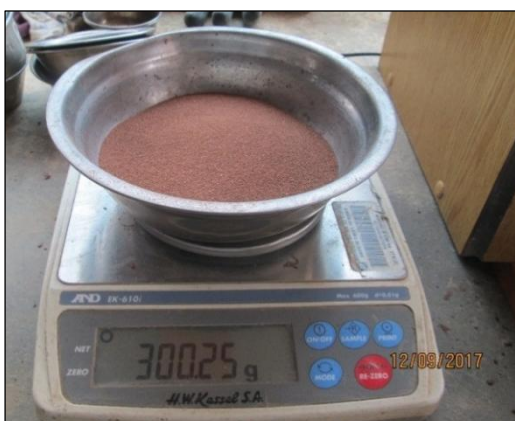
Figura 10. Peso del material pasante el tamiz número 40
