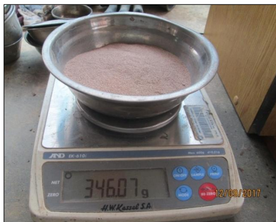
Figura 15. Peso del material pasante el tamiz número 40 Fuente: Elaboración propia
