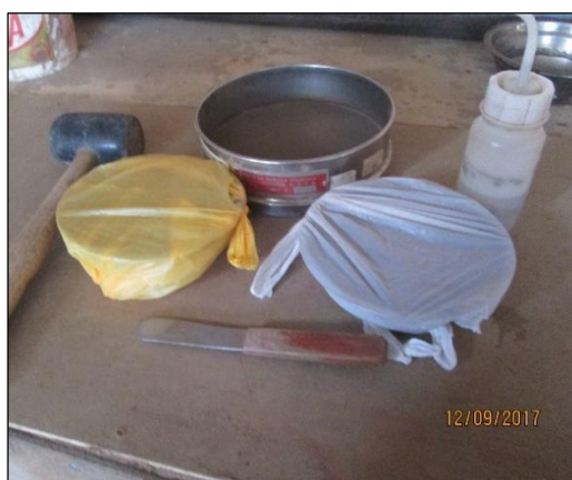
Figura 11. Humedecer la muestra por 24 h. con agua destilada
