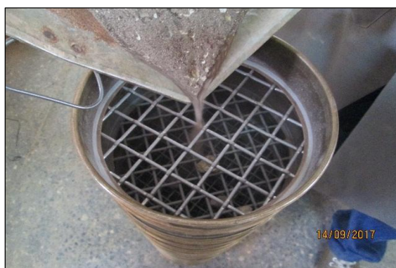
Figura 12. Puesta del material para su posterior tamizado
