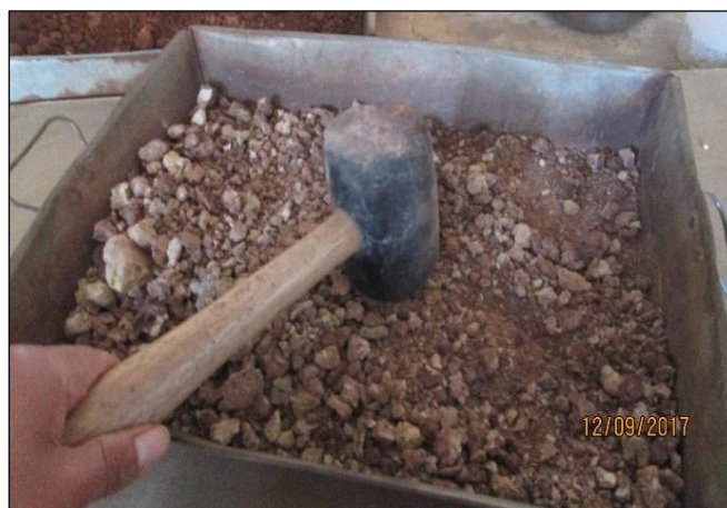
Figura 34. Chancado del material Fuente: Elaboración propia
