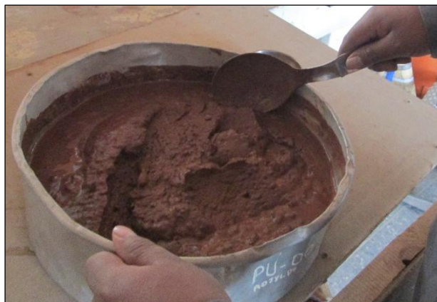
Figura 24. Muestra remodelada y saturada Fuente: Elaboración propia
