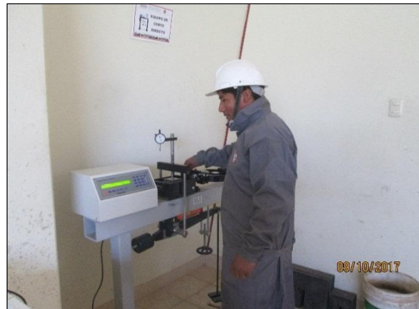
Figura 48. Equipo de corte directo para el dial de carga Fuente: Elaboración propia
