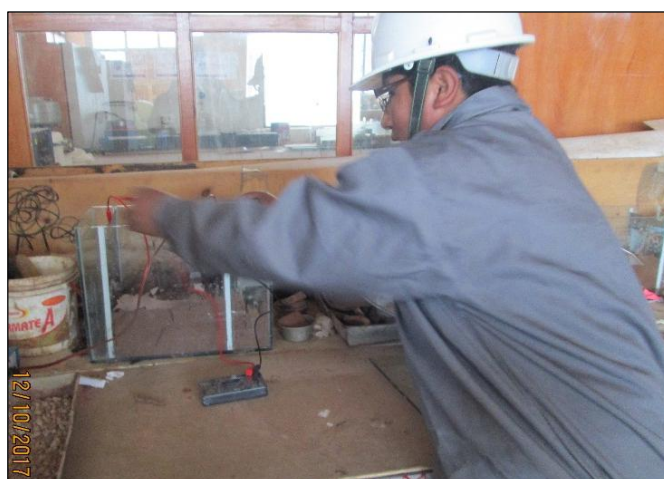
Figura 40. Medición del voltaje con el multímetro para el proceso de electroósmosis Fuente: Elaboración propia
