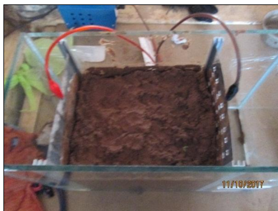
Figura 27. Proceso de electroósmosis Fuente: Elaboración propia
