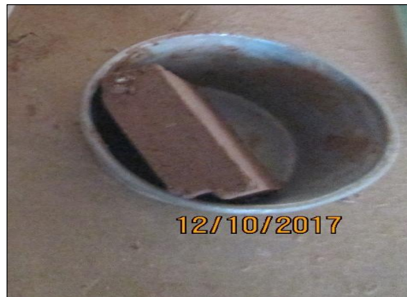
Figura 50. Muestra con falla pos electroósmosis Fuente: Elaboración propia
