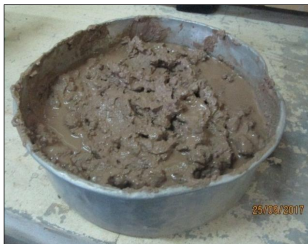
Figura 36. Muestra remoldeada y saturada Fuente: Elaboración propia
