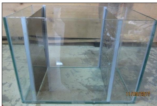
Figura 18. Espacio en la cubeta de vidrio para recolección de agua drenada
