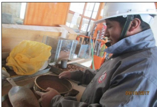
Figura 19. Tamizado del material cantera Salcedo Fuente: Elaboración propia
