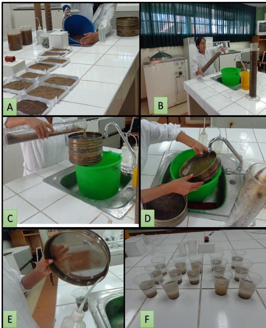
**Figura 7.** Método de tamizado en húmedo y decantación para la extracción de esporas. **a)** Muestra de 100g de suelo, **b)** Homogenización de la muestra, **c)** Pasar por tamiz el sobrenadante, **d)** Lavar con agua restos de materia orgánica, **e** y **f)** Colectar la muestra de tamiz 45 micras para la centrifugación.
