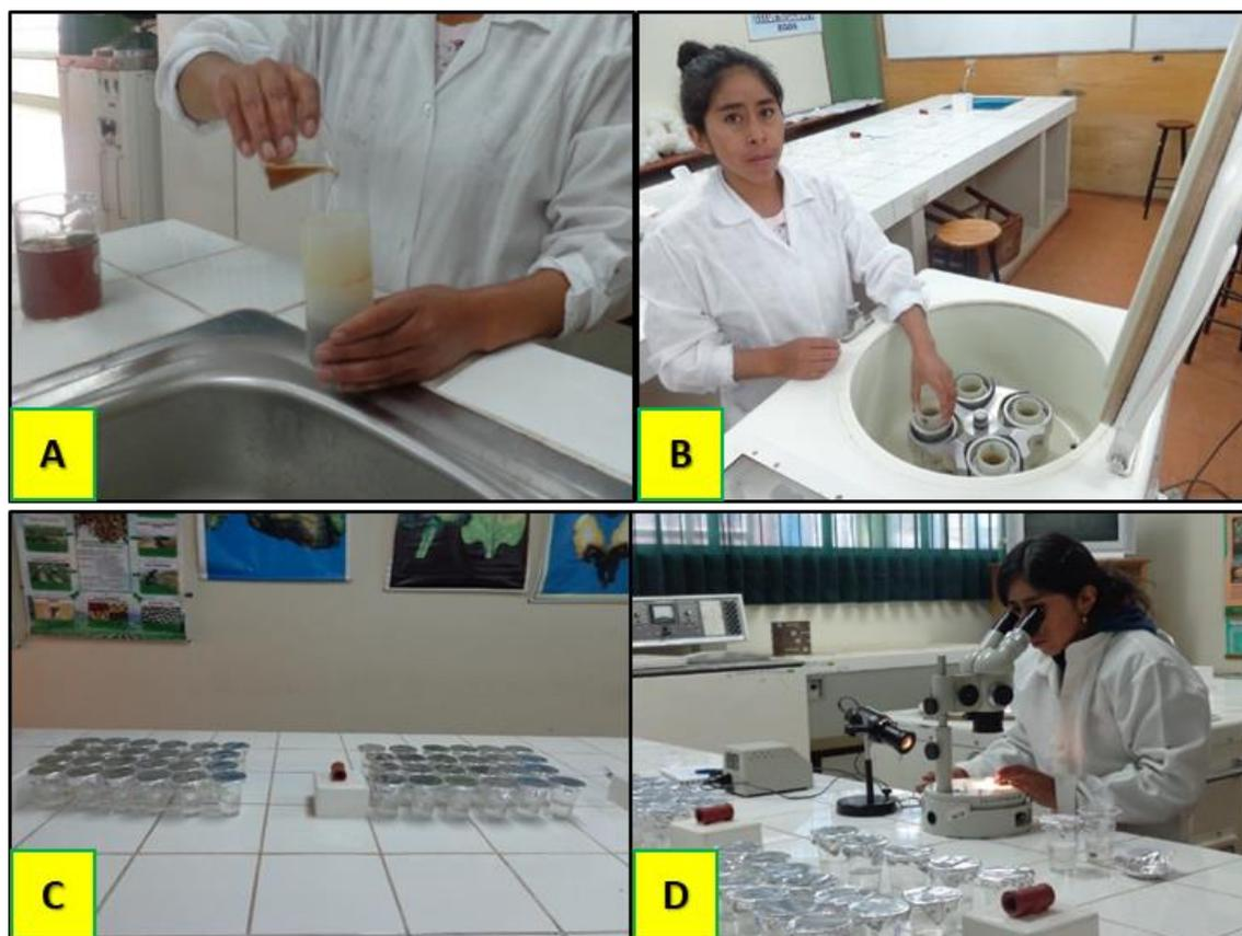
**Figura 8.** Método de centrifugación para extracción de esporas en muestras de suelo con solución sacarosa. a). Solución sacarosa al 50% para extracción de esporas b). Proceso de centrifugación 2500 rpm durante cinco min y 1600 rpm tres min., c). Muestras colectadas en vasos, d). Lectura de muestras.
