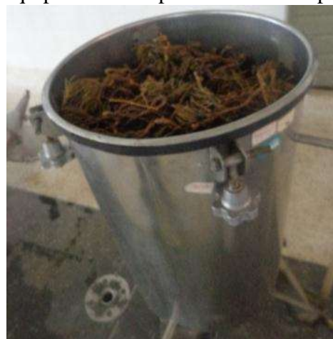
Equipo extractor por arrastre de vapor
